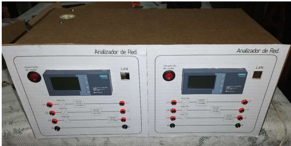
FIGURA 19: Elaboración de estructura modelo de dispositivos de medición secundarios para presentación a fabricante de estructura metalmecánica. Fuente: Los autores.
