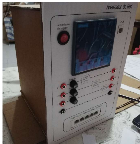
FIGURA 17: Elaboración de estructura modelo para presentación a fabricante de estructura metalmecánica. Fuente: Los autores. [18]
