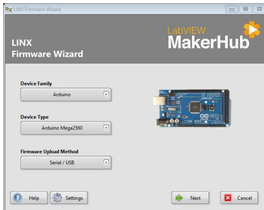
Figura 7. Se selecciona la placa de Arduino que se está usa.
