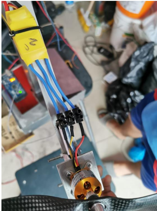
Figura 59. Conexión de driver controlador de velocidad del motor sin escobillas.
