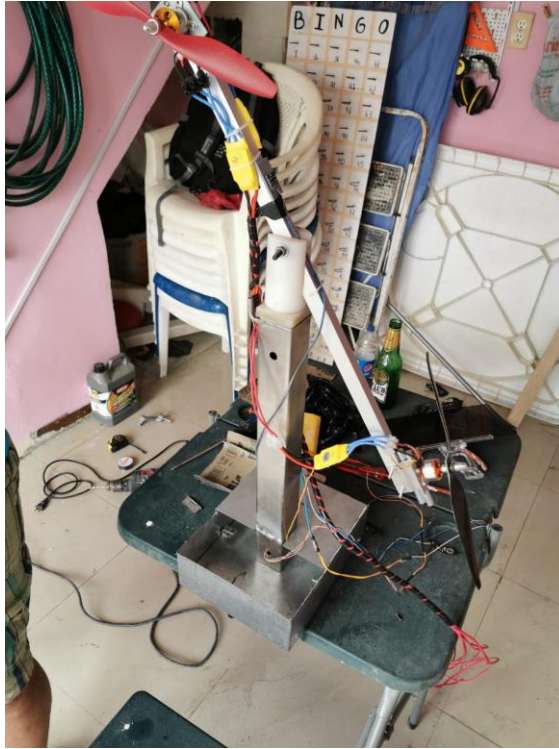
Figura 60. Montaje de motores y cableado eléctrico.
