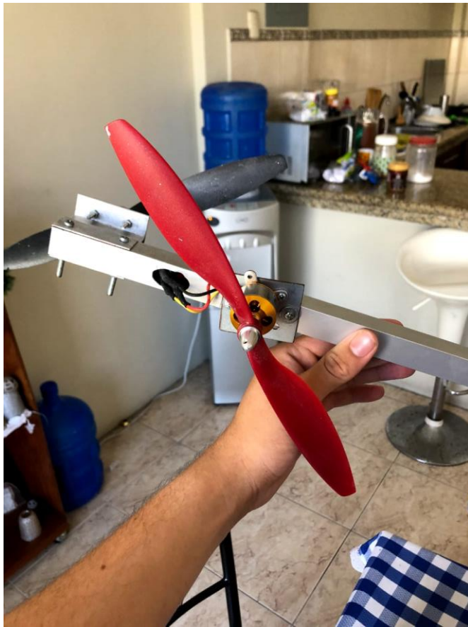
Figura 52. Instalación de motores sin escobilla en el balancín.
