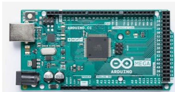
Figura 7. Tarjeta Arduino Mega 2560. (Arduino corp., 2020)
