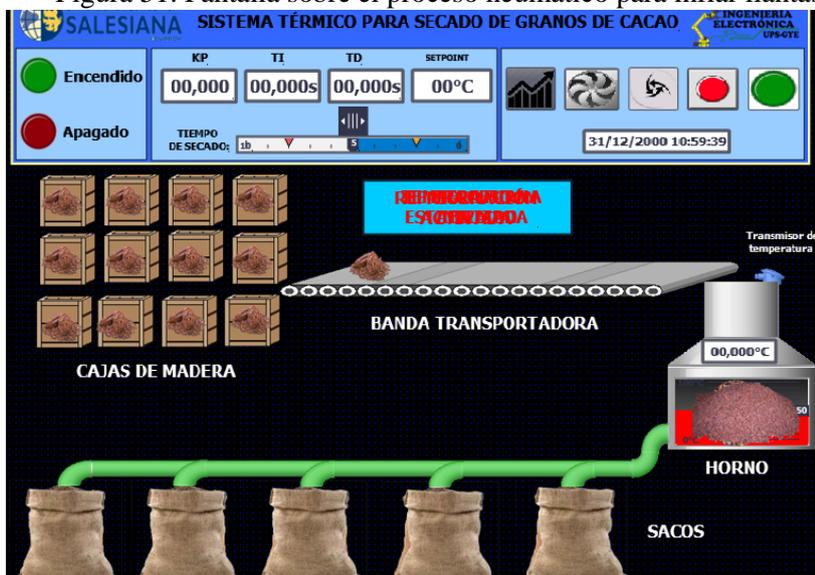
Figura 52. Pantalla sobre el proceso térmico para secar las semillas del cacao
