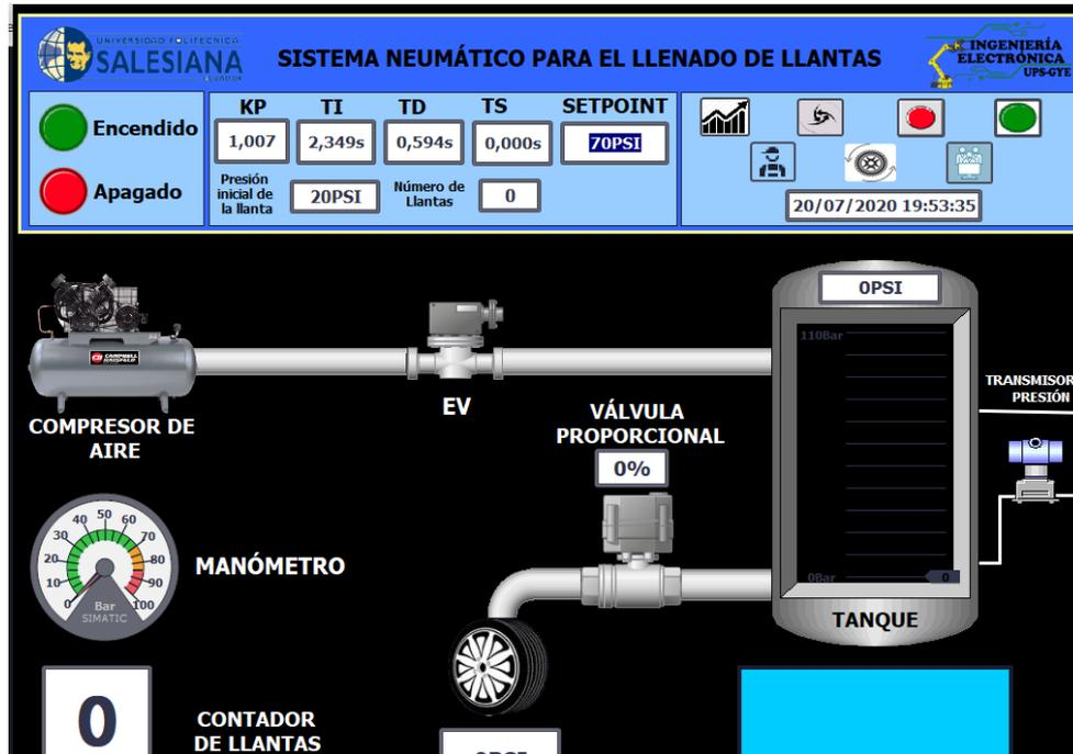
Figura 71. Simulación del proceso industrial de la práctica #2 en un SCADA
