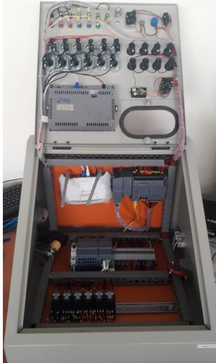
Figura 60. Cableado interno del módulo didáctico
