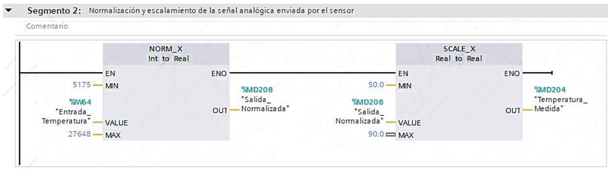
Figura 139. Normalizar y escalar de la señal analógica enviada por el sensor
