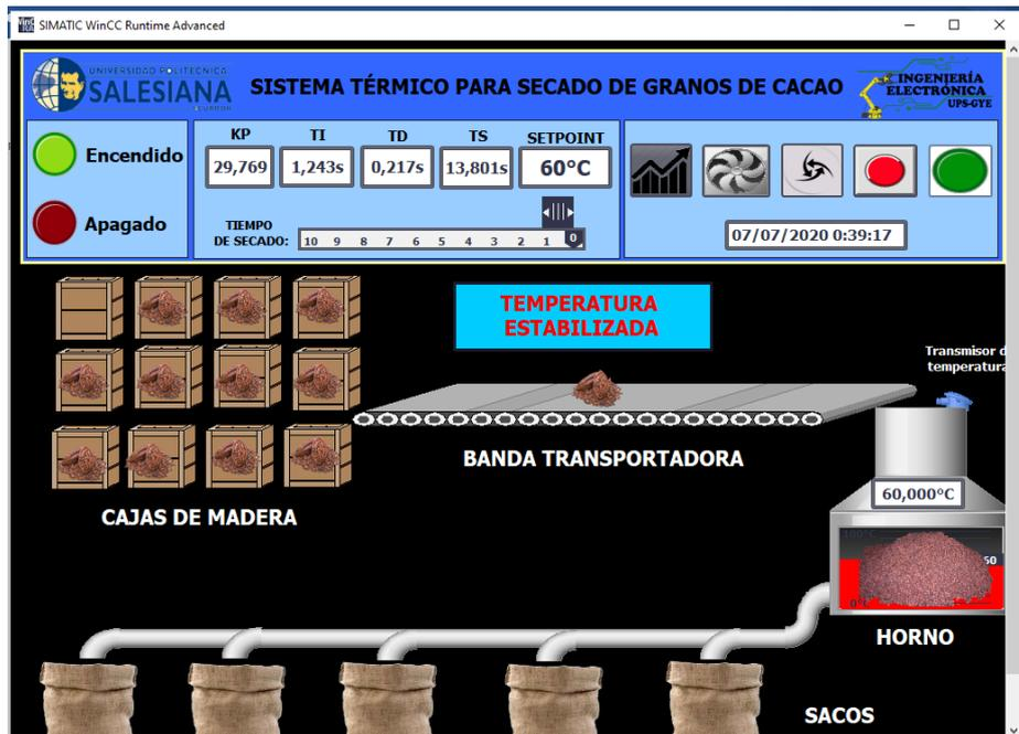
Figura 73. Simulación del proceso industrial de la práctica #3 en un SCADA
