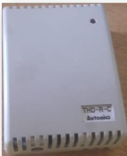
Figura 40. Transmisor de temperatura THD-R-C
