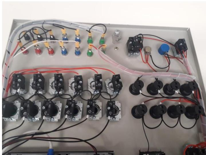
Figura 57. Cableado de los elementos que componen la tapa superior del módulo didáctico
