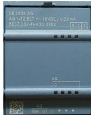
Figura 19. Signal board de salidas analógicas
