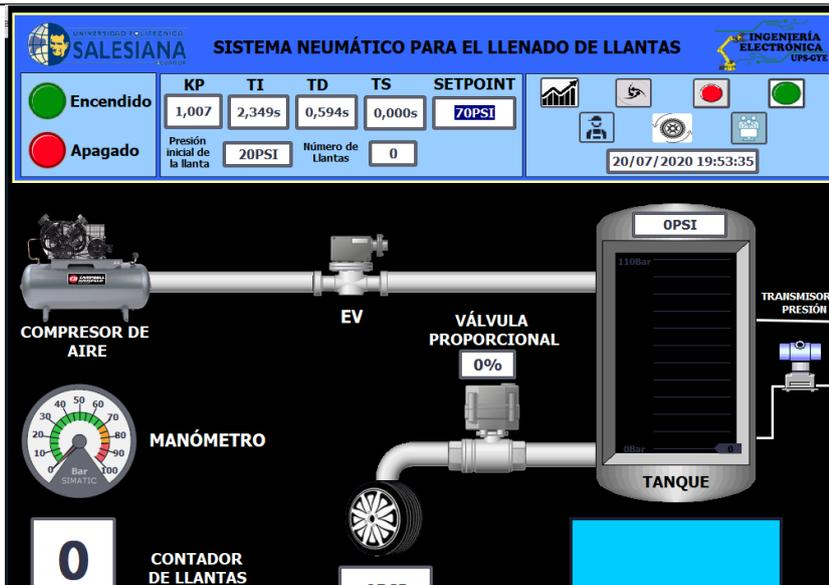
Figura 51. Pantalla sobre el proceso neumático para inflar llantas
