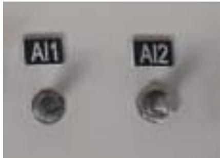
Figura 27. Potenciómetros
