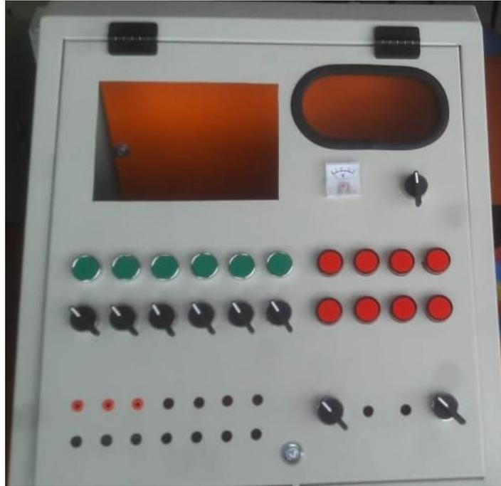
Figura 56. Colocación de luces piloto, pulsadores y selectores para el módulo didáctico
