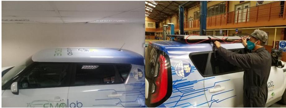
Figura 57: Colocación y sujeción de paneles solares al VE.
