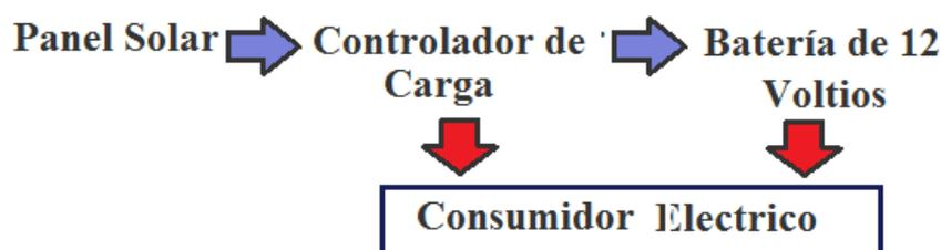
Figura 18: Esquema de Funcionamiento de un Circuito de Carga
