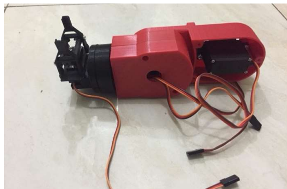
Figura 37. Unión del quinto, cuarto y tercer eslabón brazo robótico RV-2AJ
