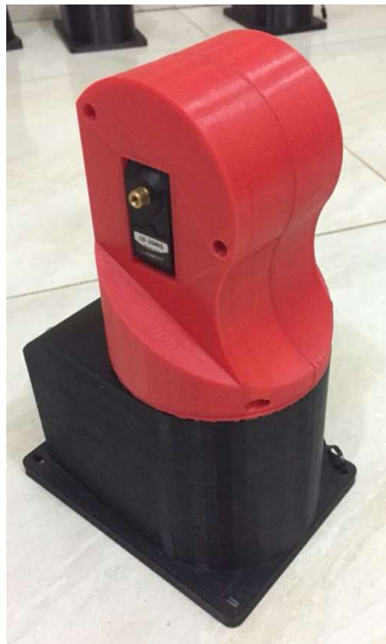
Figura 29. Primer eslabón de conexión con la base del brazo robótico RV-2AJ.
