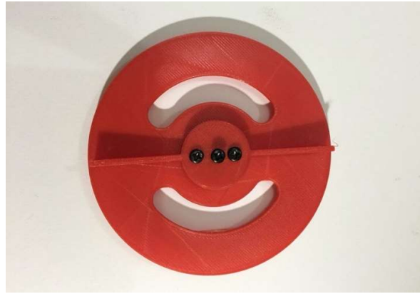
Figura 28. Disco del movimiento de la base del brazo robótico RV-2AJ.
