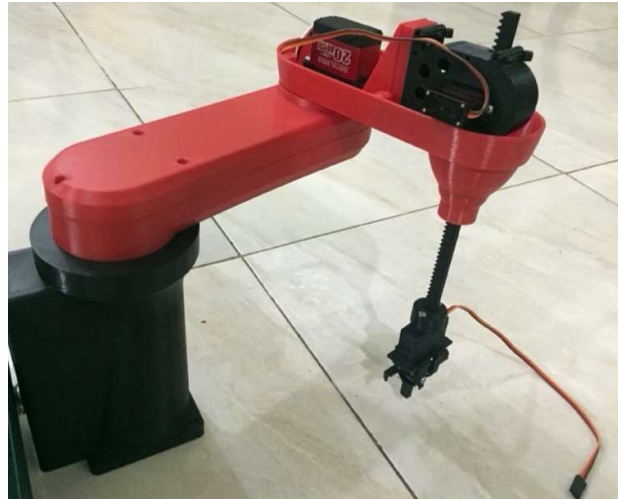
Figura 34. Unión del segundo y tercer eslabón del brazo robótico KUKA R550
