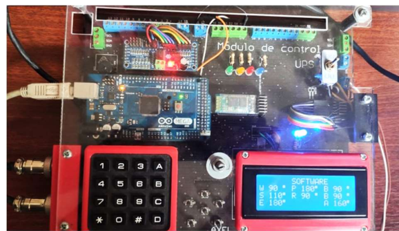
Figura 65. Módulo de control, posicionamiento de los eslabones del RV-2AJ
