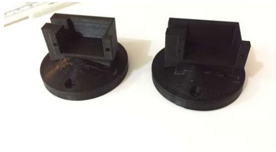
Figura 26. Base de la pieza comunión al eslabón de brazo robótico RV-2AJ.
