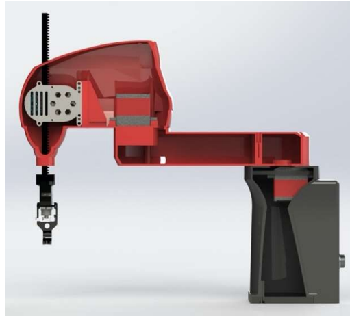
Figura 18. Estructura y diseño interno del brazo KUKA R550
