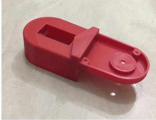
Figura 30. Tercer eslabón del brazo robótico RV-2AJ.
