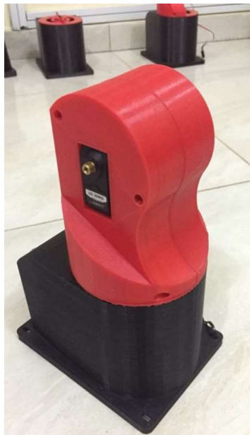
Figura 39. Primer eslabón del Brazo robótico RV-2AJ
