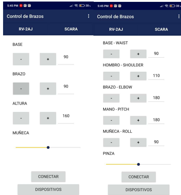
Figura 67. Controlador de los brazos robóticos
