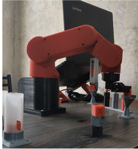
Figura 73. Brazo robótico RV-2AJ clasificando pieza cilíndrica
