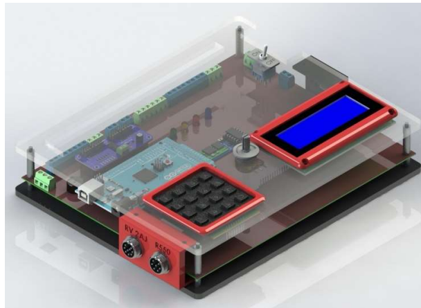
Figura 42. Diseño estructural de la tarjeta del módulo de control.
