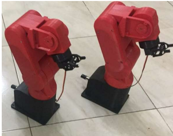
Figura 40. Unión de todos los eslabones del Brazo robótico RV-2AJ
