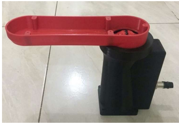
Figura 32. Segundo eslabón del brazo robótico KUKA R550
