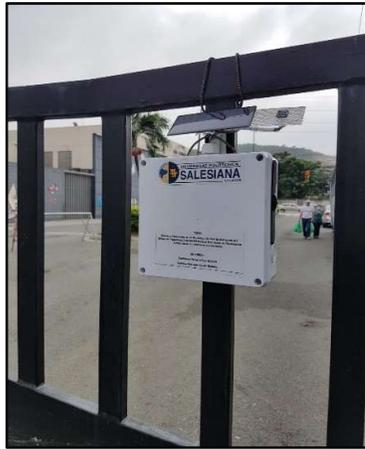
Imagen 59. Instalación de nodo sensor outdoor [Autor]
