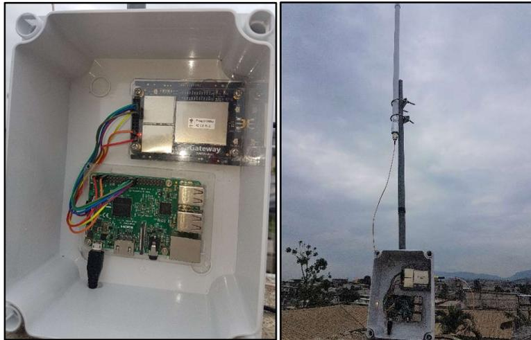
Imagen 39. Vista frontal y antena del nodo Gateway [Autor].
