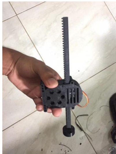
Figura 24. Impresión y unión con el servo para movimiento del eslabón 3.
