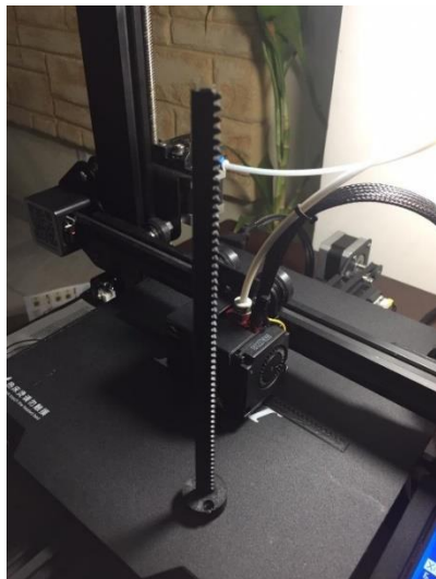
Figura 23. Impresión para el movimiento de la pinza en vertical.
