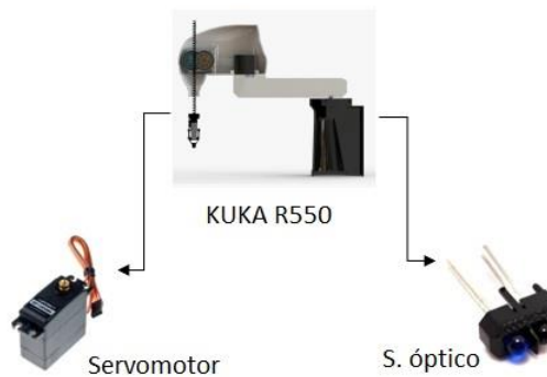
Figura 19. Diagrama estructural de KUKA R550
