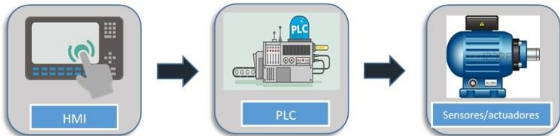
Figura 11. Diagrama de bloques de un HMI. (Autracen.com, 2017)
