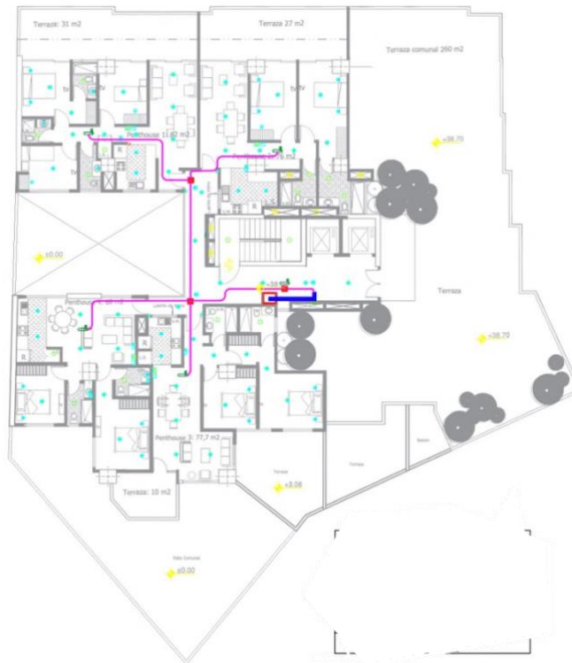
Distribución de APs en el Piso 12. Elaborado por: Chinachi Andrés, Rios Jorge.
