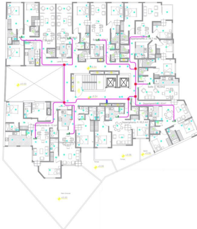
Distribución de cableado del Piso 3 al Piso 11. Elaborado por: Chinachi Andrés, Ríos Jorge.
