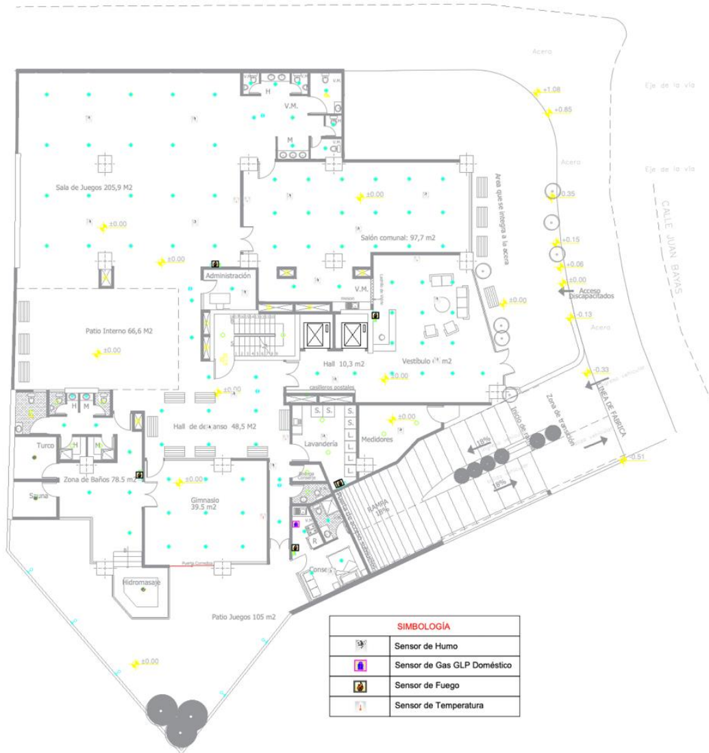
Distribución de sensores en la Planta Baja. Elaborado por: Chinachi Andrés, Rios Jorge.
