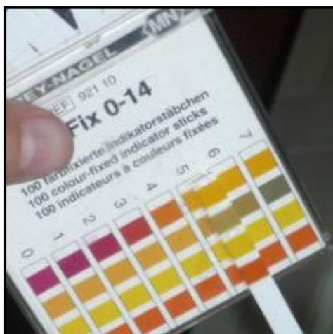
**ILUSTRACIÓN 15:** Toma de Muestra del pH de uno de los Biodigestores.
