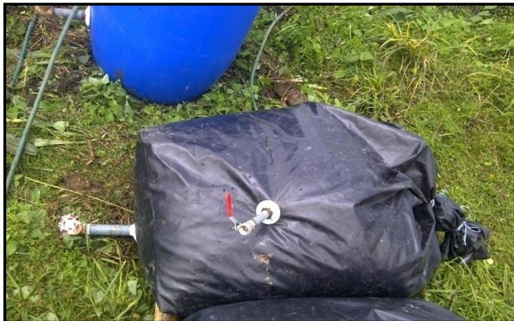
**ILUSTRACIÓN 9:** Biodigestor de Bolsa.
