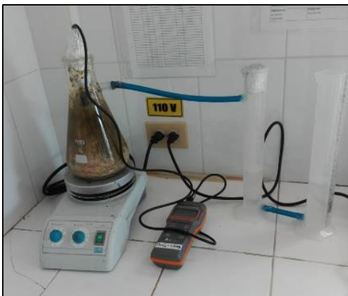
Gasómetro 1 de la mezcla 1
