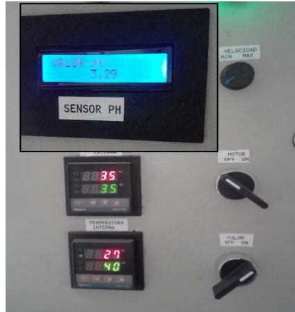
pH y temperatura una vez cargado los residuos orgánicos en el biorreactor
