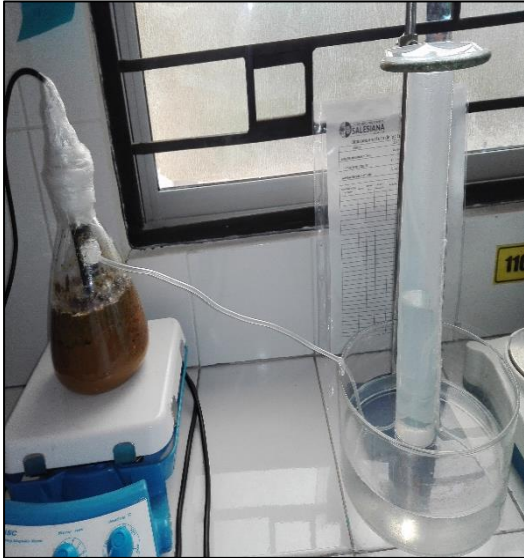
Gasómetro 2 de la mezcla 3
