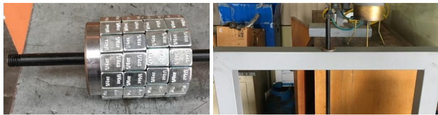
Figura 48. Montaje Masa de Impacto-Eje Guía.
