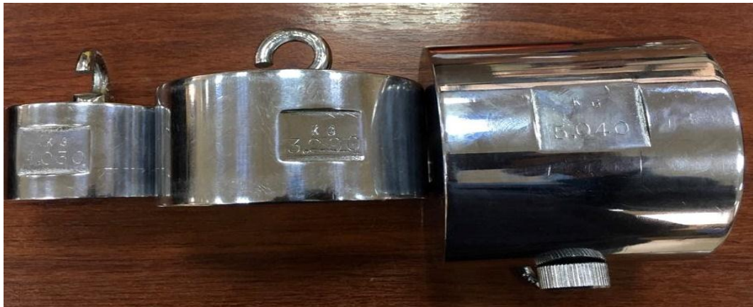
Anexo 1. Masas para obtener la Curva Característica del Sensor FSR.
