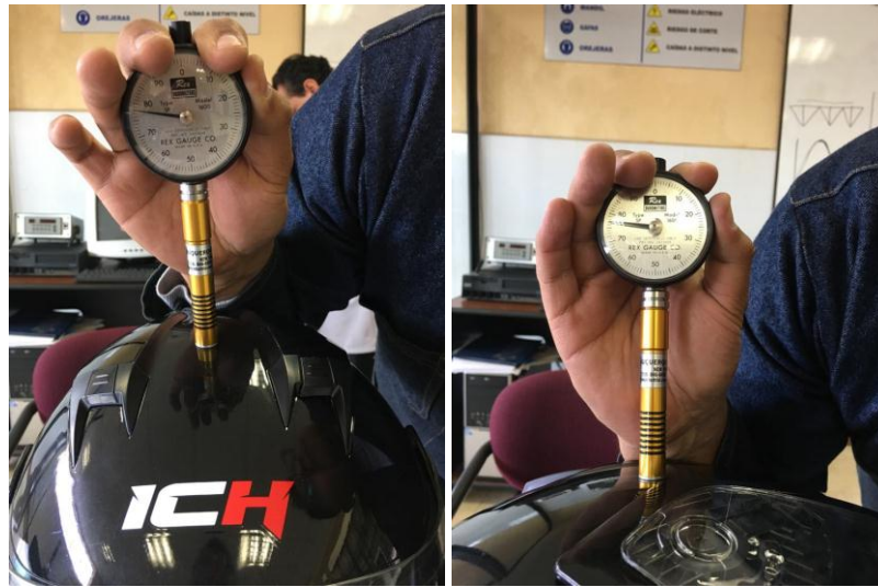
Anexo 10. Prueba de Presión longitudinal y Transversal Casco 4.
