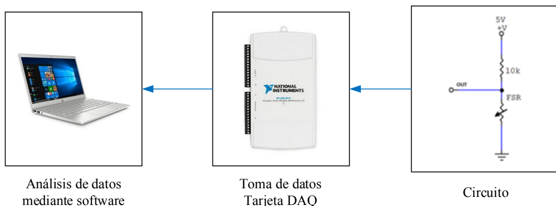
Figura 38. Esquema de Recolección de Datos del Sensor FSR. Fuente: Autores.
