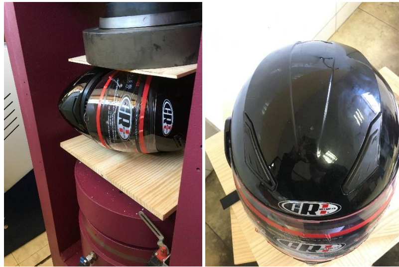
Anexo 14. Prueba de Rigidez Casco 3.
