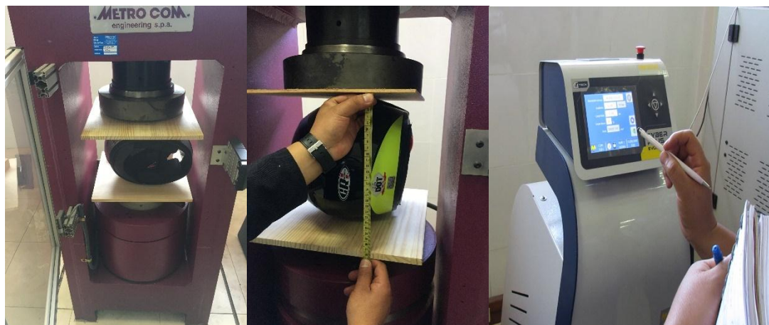
Figura 74. Proceso para toma de datos del Ensayo de Rigidez.
