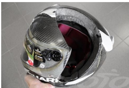
Figura 7. Casco de motocicleta material ESP. Fuente: (EnjoyTheRide, 2018)
