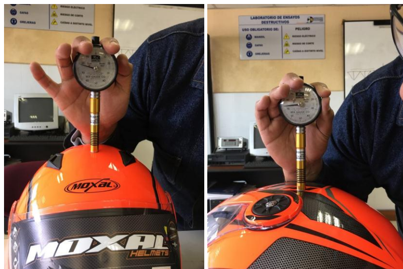
Anexo 10. Prueba de Presión longitudinal y Transversal Casco 4.
