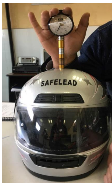
Figura 68. Ubicación del durómetro sobre la superficie del Casco. Fuente: (Autores)
