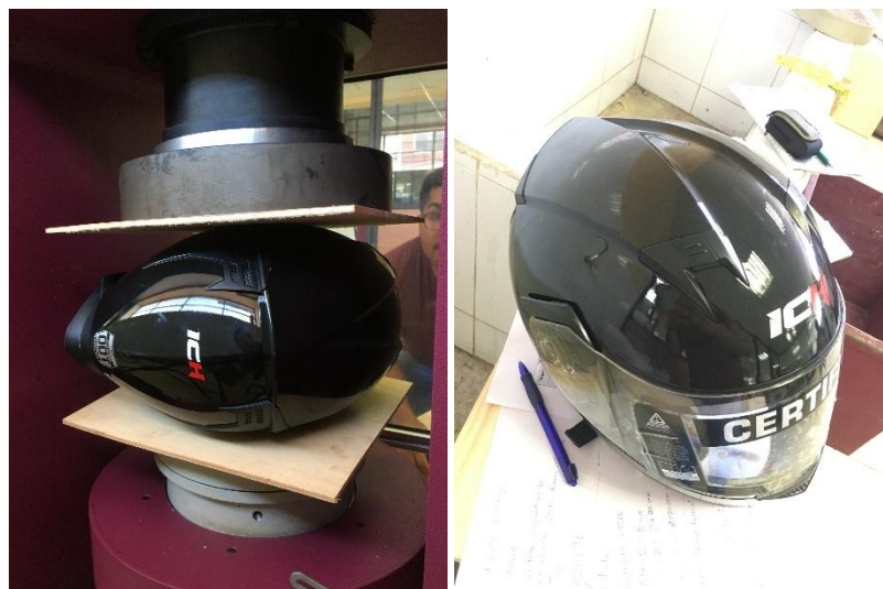
Anexo 14. Prueba de Rigidez Casco 3.
