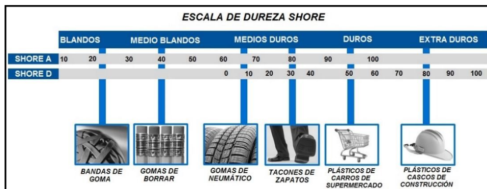
Figura 33. Escala de dureza A y D en diferentes aplicaciones. Fuente: (Introducción al Durómetro, 2015)
