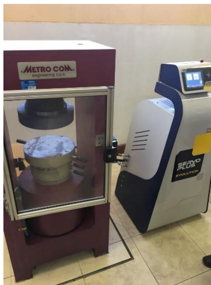
Figura 35. Máquina de Ensayo de Compresión 3000 KN. Fuente: Laboratorio de Ensayos Destructivos U.P.S.
