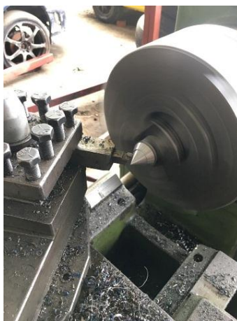
Figura 44. Cilindrado cónico a 60°.
