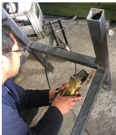
Figura 45. Pulido de la estructura.
