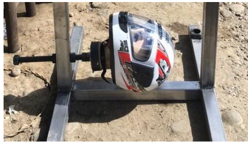
Figura 47. Sujeción del Casco de prueba sobre la estructura.
