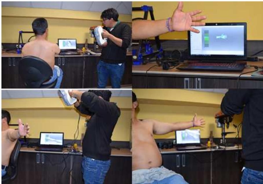
Figura. 61 Medidas tomadas con escaner ARTEC EVA.
