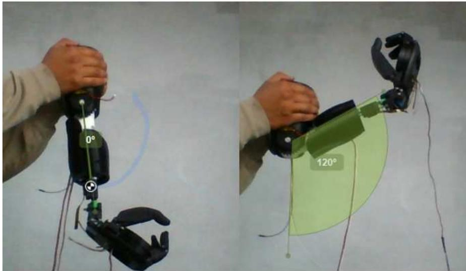
Figura. 105 Prueba de funcionamiento de Flexión-extensión de codo.
