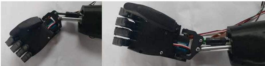
Figura. 107 Prueba de funcionamiento de Desviación Radial-Cubital.
