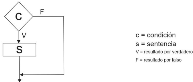
Figura 13. Diagrama de flujo de la estructura selectiva simple
