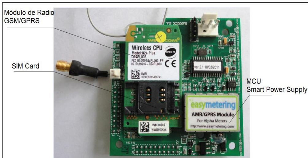
**Figura 3.7.** Módulo de comunicación AMR GPRS para los medidores inteligentes.
