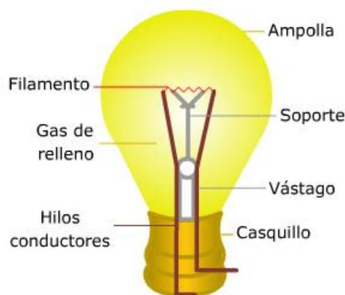
**Fig. 1.40 Lámpara Incandescente no Halógena**
