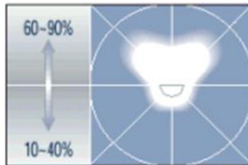
**Fig. 1.23 Flujo Luminoso Sistema Semi- Indirecto**
