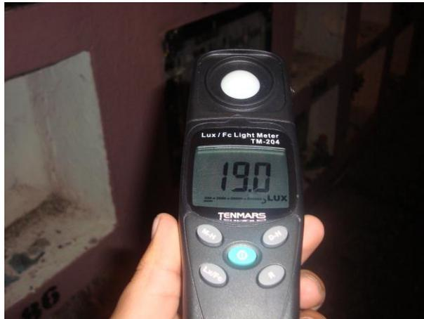
**Foto 2.25** Medición de nivel de iluminación en bóvedas del Cementerio General Cuenca
