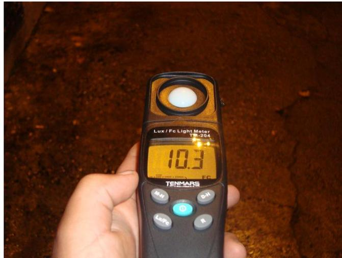
**Foto 2.26** Medición del nivel de iluminación en cominerías del Cementerio General Cuenca (1)
