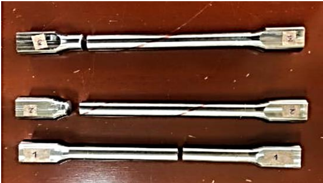
Figura 29. Probetas fracturadas en ensayo de torsión experimentalmente [2].
