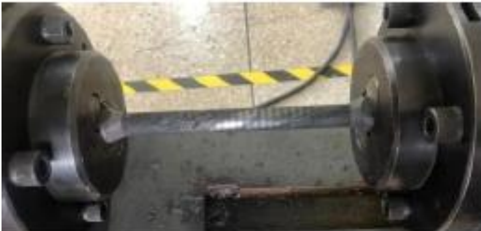
Figura 16. Ensayo de torsión a probetas con tratamiento térmico [2].
