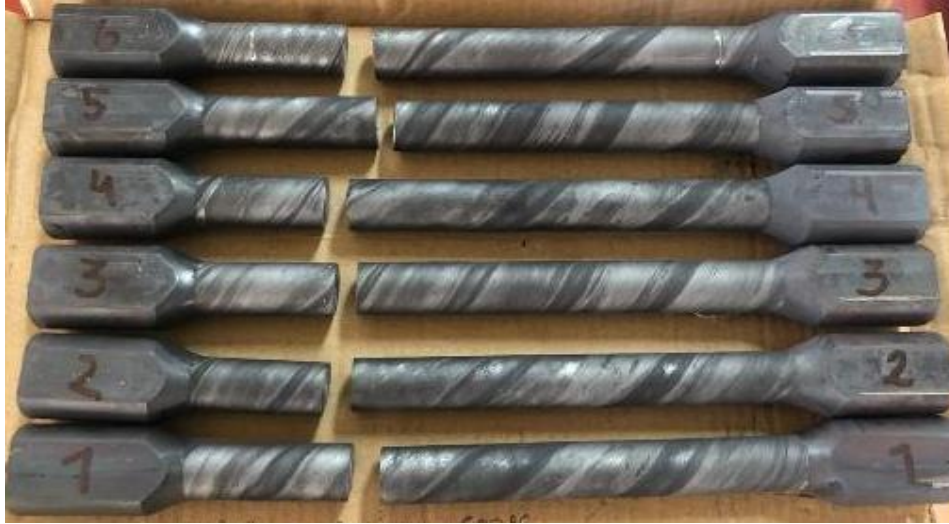
Figura 47. Probetas templadas a 860 (°C), revenido 500 (°C), fracturadas en ensayo de torsión experimentalmente [2].
