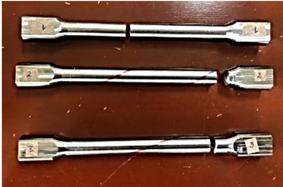
Figura 43. Probetas en estado de suministro fracturadas, ensayo de torsión experimentalmente [2].
