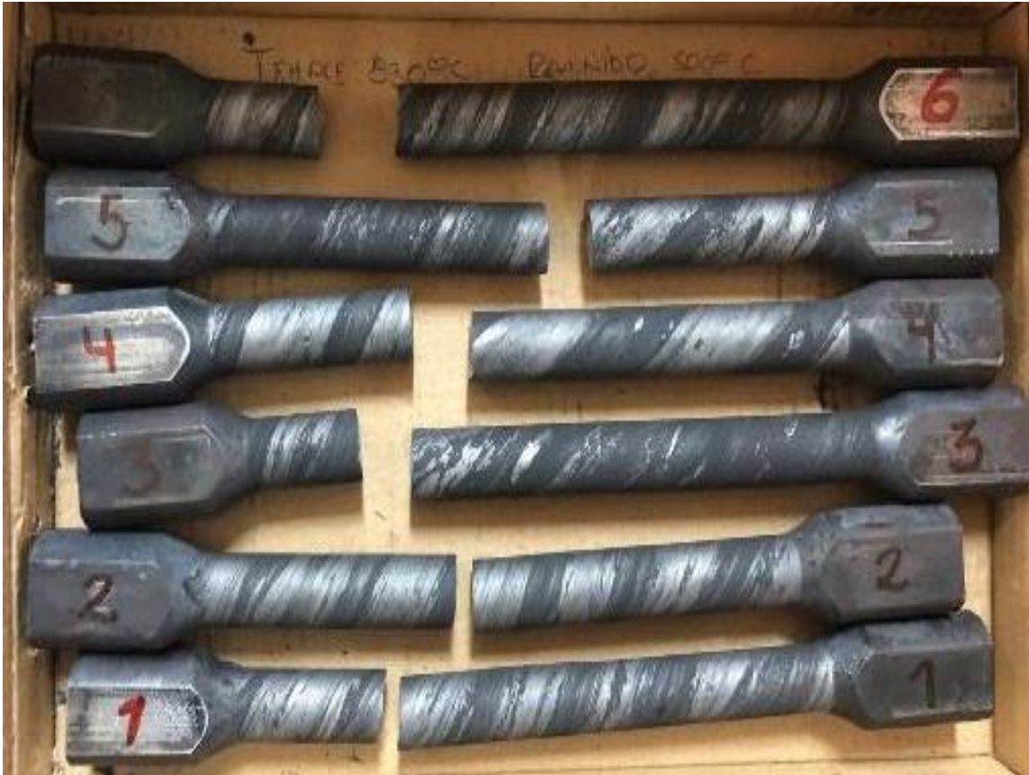
Figura 45. Probetas con temple a 830 °C y revenido a 500 °C, fracturadas en ensayo de torsión experimentalmente [2].
