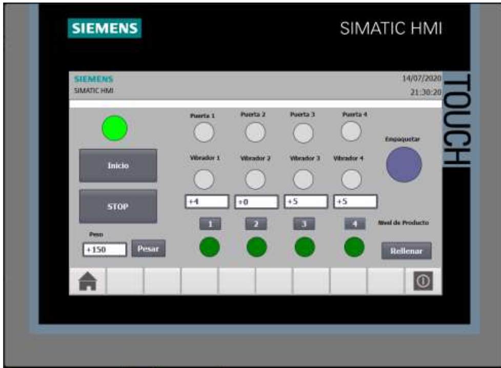
Figura 70. Pantalla HMI en proceso completo de llenado de 150 gramos de producto Elaborado por: Jonathan Carrillo & Stalin Montenegro
