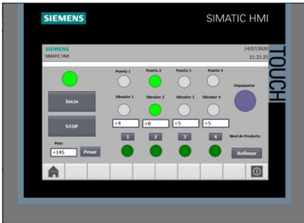
Figura 71. Pantalla HMI- accionamiento indicadores de bandeja B (llenado 145 gramos) Elaborado por: Jonathan Carrillo & Stalin Montenegro
