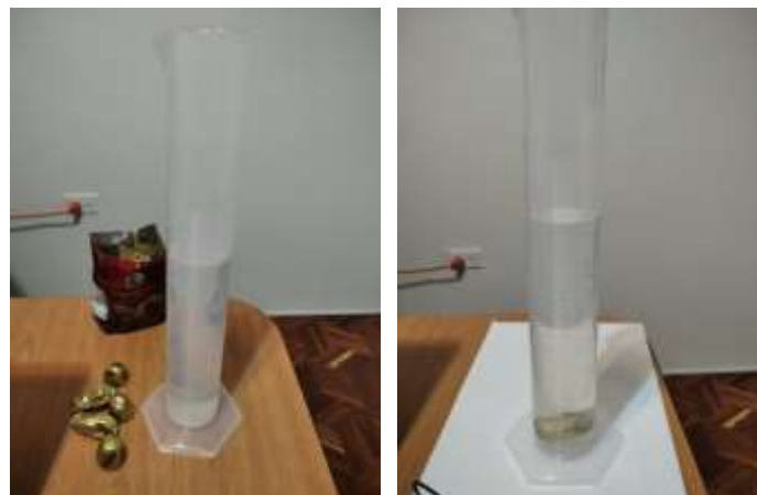
Figura 25. Medición de los volúmenes de los diferentes tipos de chocolates Elaborado por: Jonathan Carrillo & Stalin Montenegro
