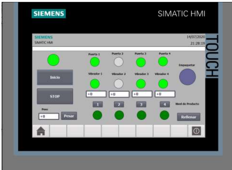
Figura 69. Pantalla HMI en modo inicio de ciclo Elaborado por: Jonathan Carrillo & Stalin Montenegro
