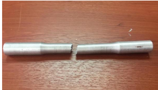
Figura 28. Rotura de Probeta, Autores
