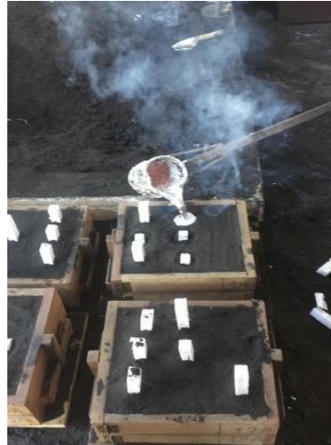
Figura 19. Colado del material, Autores
