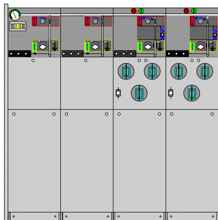
Figura 1.10 Unidad encapsulada con aislamiento SF 6 .
