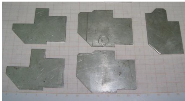
Figura 3.52 Placas de soporte de aluminio para servomotores.
