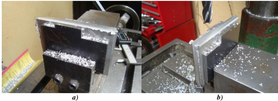
Figura 3.51 Mecanizado de placas de soporte de servomotores en base a moldes.
