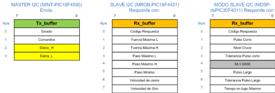
Figura 3.108 Estructura del paquete información enviada y recibida por I2C.
