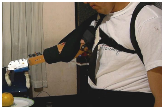
Figura 4.5 Arnés para sostener el peso del brazo.
