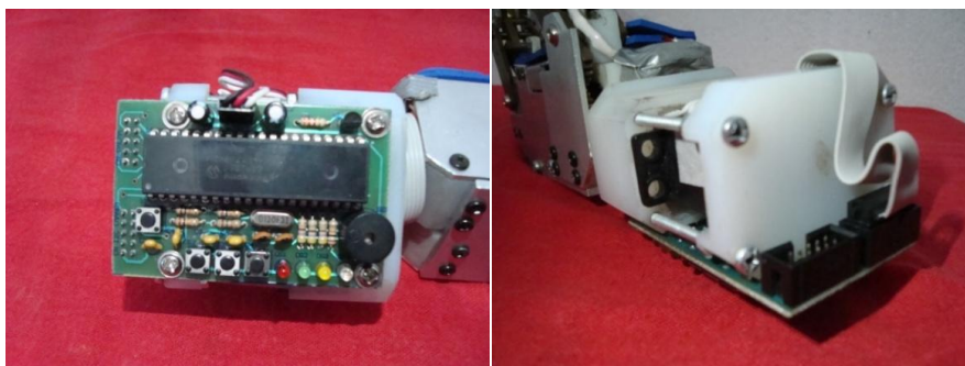
Figura 3.71 Montaje de tarjeta de electrónica de control de la mano robot.
