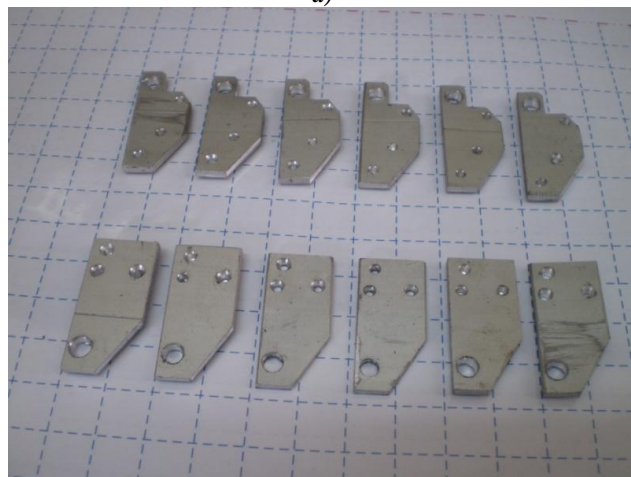
Figura 3.36 Falanges de aluminio 1 y 2 para todos los dedos. a) Vista frontal. b) Vista lateral.
