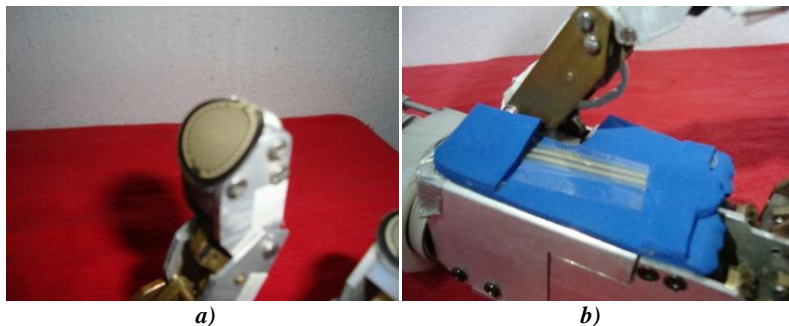
Figura 3.69 a) Fijación de sensor sobre cada dedo. b) Fijación sobre la palma de la mano.
