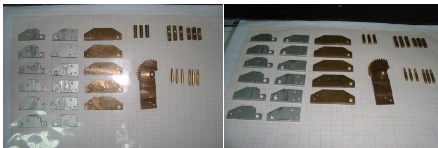
Figura 3.45 Falanges y piñones listos para ser ensamblados.
