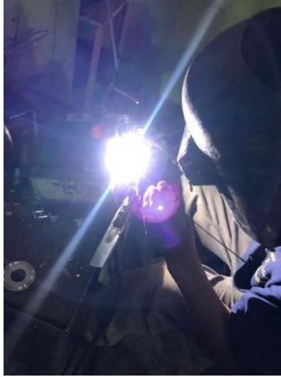
Soldadura de bases de los cilindros. Elaborado por: Christian Carpio y Daniel Sani
