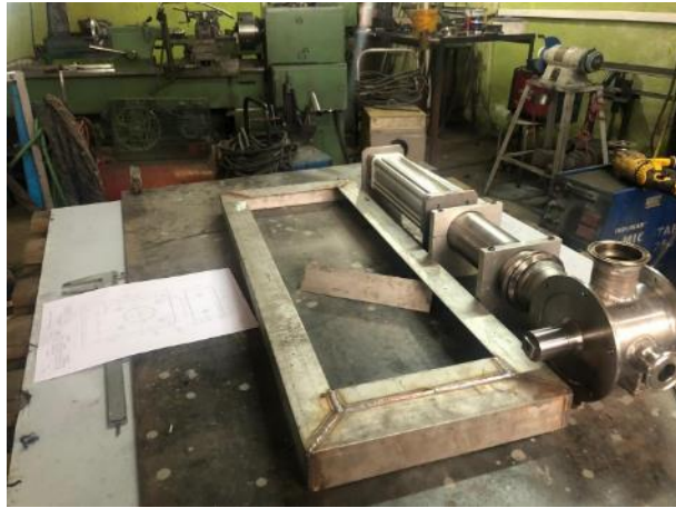
Ensamblaje de pistón neumático con cámara y carcasa de válvula rotativa. Elaborado por: Christian Carpio y Daniel Sani
