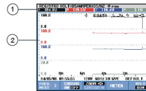
La pantalla Tendencia muestra los cambios durante un periodo de tiempo de los valores de medida en una fila de la pantalla Multímetro. Se muestra como ejemplo la tabla TENDENCIA VOLT /AMP /HZ. El tiempo aparece de forma horizontal. Los datos de la pantalla se inician desde el lado derecho. Para permitir una grabación continua de los datos, el eje del tiempo se comprime cuando es necesario.
