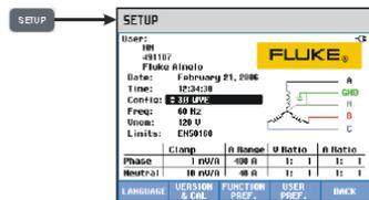
La tecla SETUP (Configurar) le permite acceder a un menú para configurar el analizador de acuerdo con sus requerimientos de medida.
