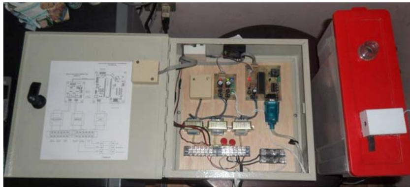
*Figura 3.37: Vista de los circuitos que forman el prototipo del Sistema de monitoreo y alarma*
