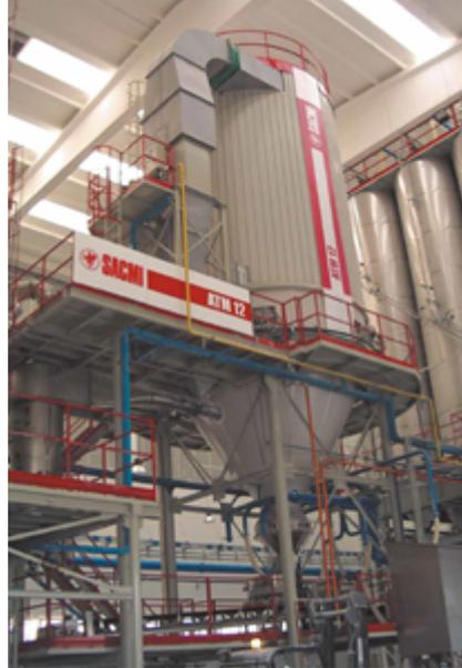
Figura 1.4: Atomizador ATM 12 del fabricante SACMI
