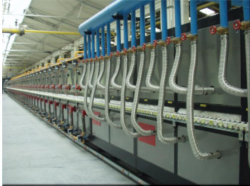
Figura 1.9: Horno de rodillos del Fabricante Italiano Welko
