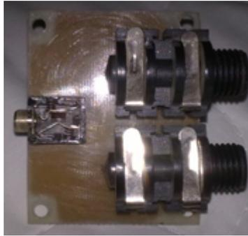
Figura 4.7: Placa de acople de los sensores con los componentes ya soldados.
