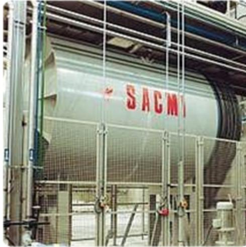
Figura 1.11: Molino de bolas del fabricante italiano SACMI
