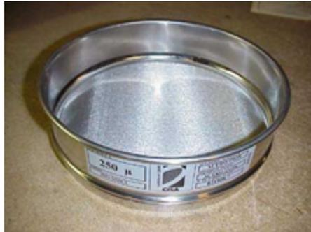
Figura 2.4: Tamiz de 250  $\mu\text{m}$
