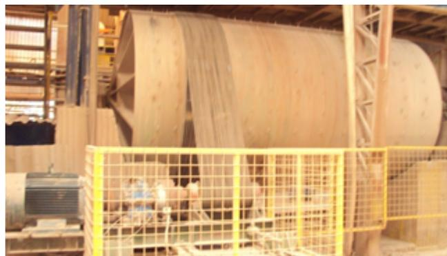
Figura 4.1: Vista del Molino con su sistema de Transmisión
