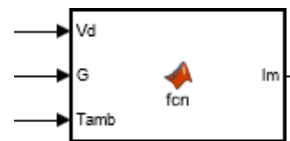
Figura 12. Bloque General del panel solar – Simulink.
