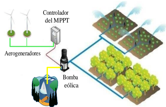
Figura 3. Componentes del sistema eólico de bombeo [27].
