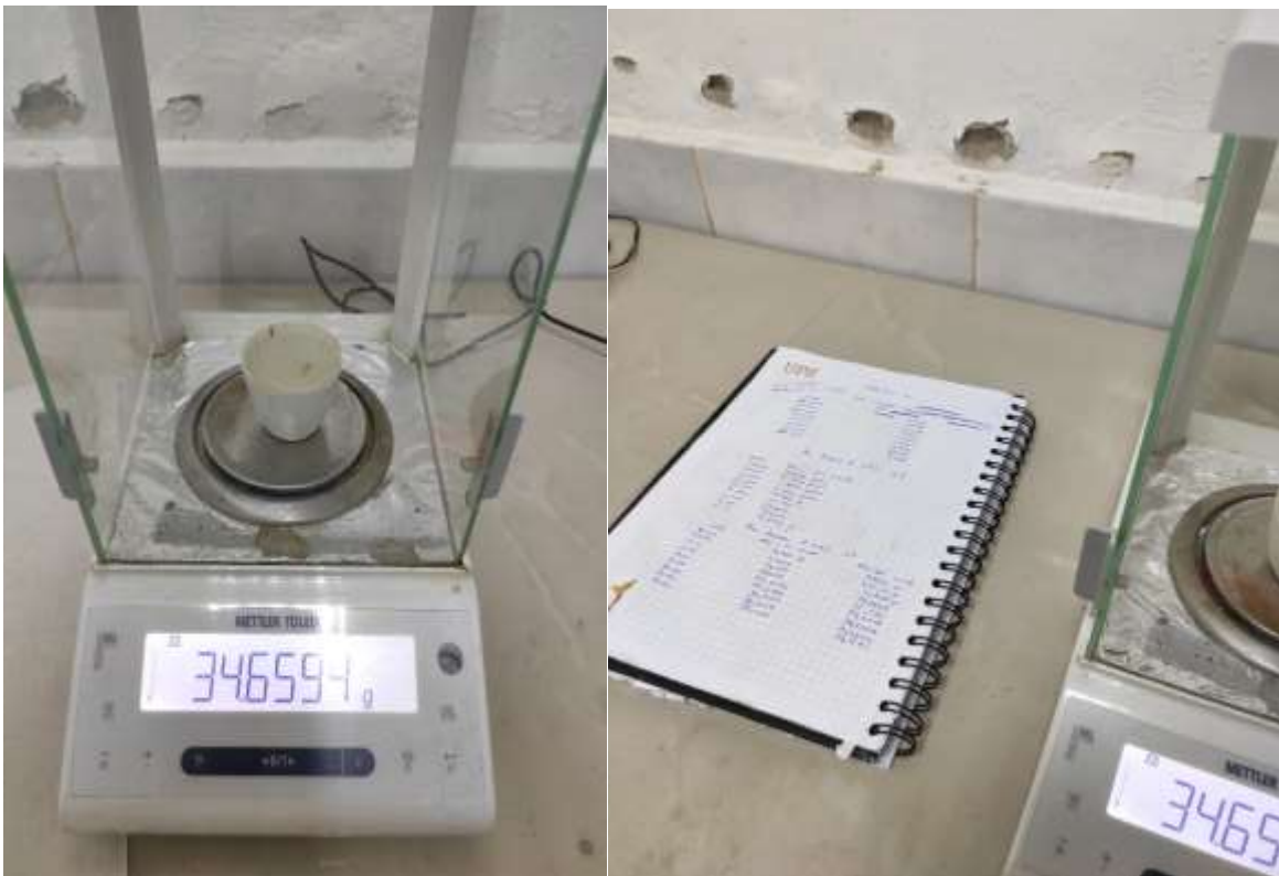
ANEXO 3. Pesado de las muestras de suelo calcinado.
