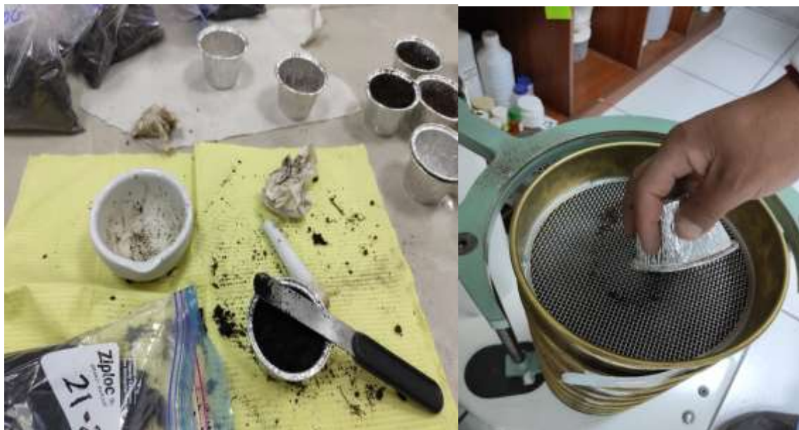
ANEXO 3. Trituración y Tamizado de las muestras de suelo.
