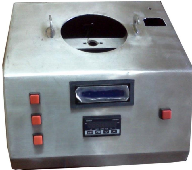
Figura 4.40 Base del reactor parte frontal
