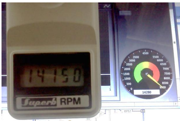
Figura 4.2 Contraste de velocidad con tacómetro digital.
