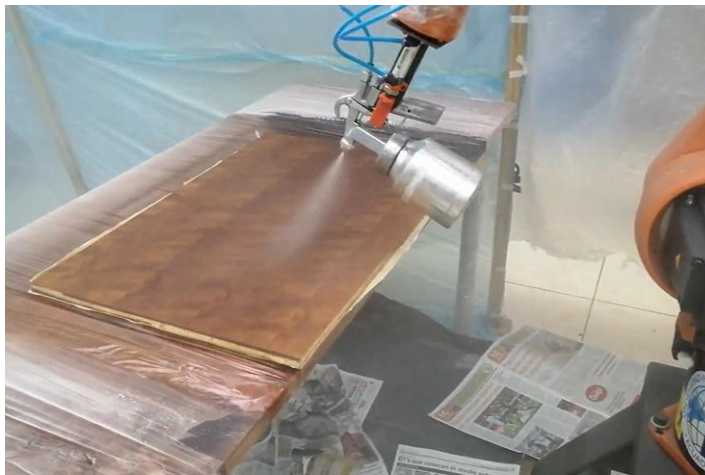
Figura 58. Pruebas de calidad en orientación horizontal.
