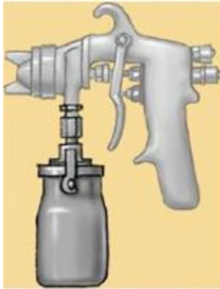
Figura 19. Pistola con alimentación por succión [6].
