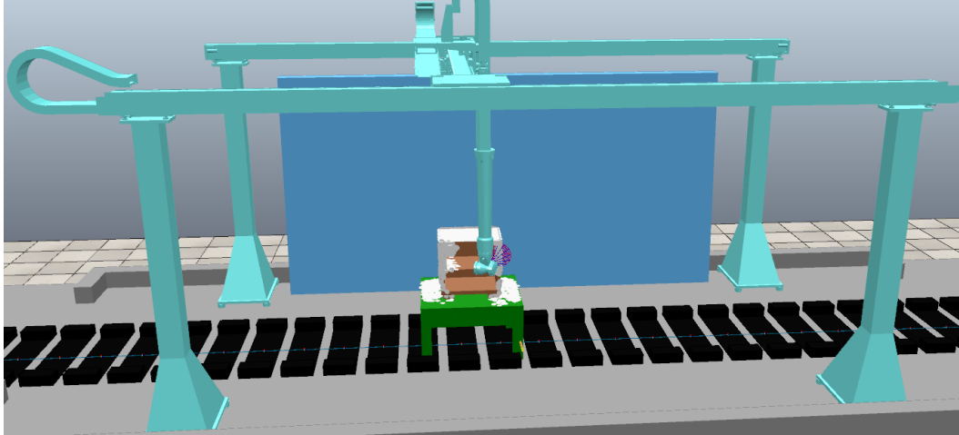
Figura 1. Sistema cartesiano proyectando sello al velador Basilea.
