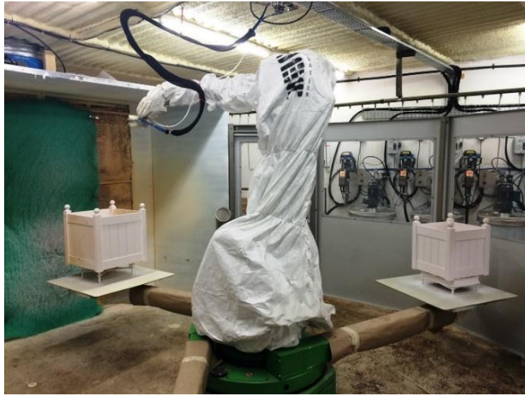
Figura 42. Robot con dos muebles en mesa giratoria [31].
