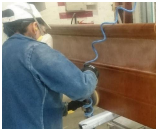
Figura 11. Proceso de lijado [Cortesía de la empresa].
