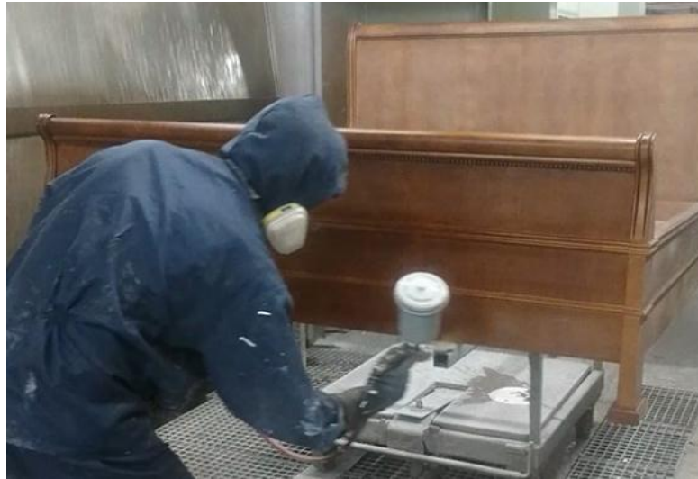
Figura 12. Proceso de retoque [Cortesía de la empresa].
