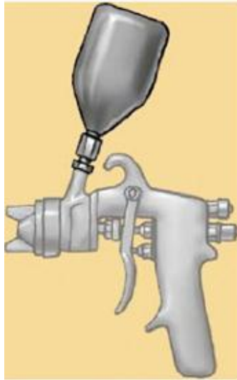
Figura 17. Pistola con alimentación por gravedad [6].
