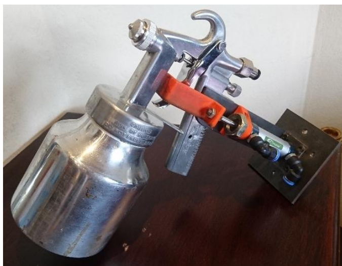
Figura 46. Efector final para las pruebas de laboratorio.
