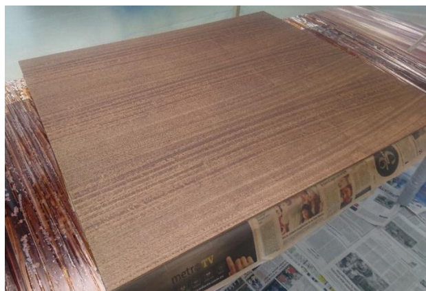
Figura 54. Tablero tinturado para las pruebas de sellado.
