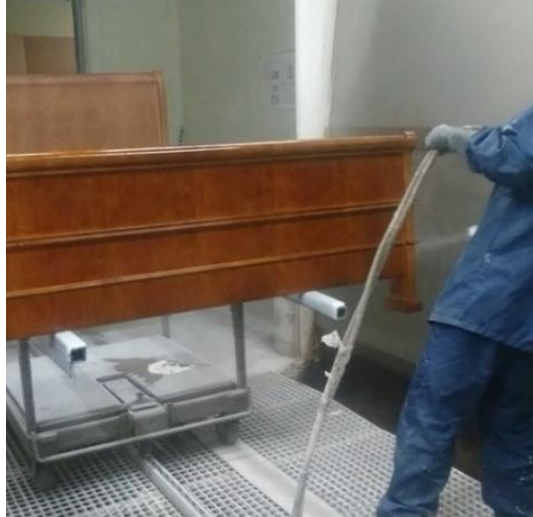
Figura 10. Proceso de sellado [Cortesía de la empresa].
