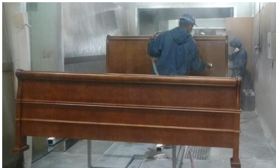
Figura 13. Proceso de lacado [Cortesía de la empresa].
