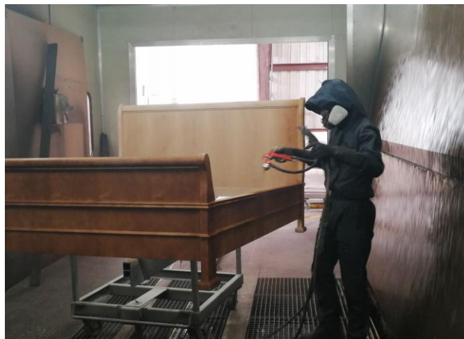
Figura 9. Proceso de tinturado [Cortesía de la empresa].
