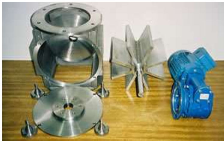
Figura 14 Sistema de descarga de un ciclón
