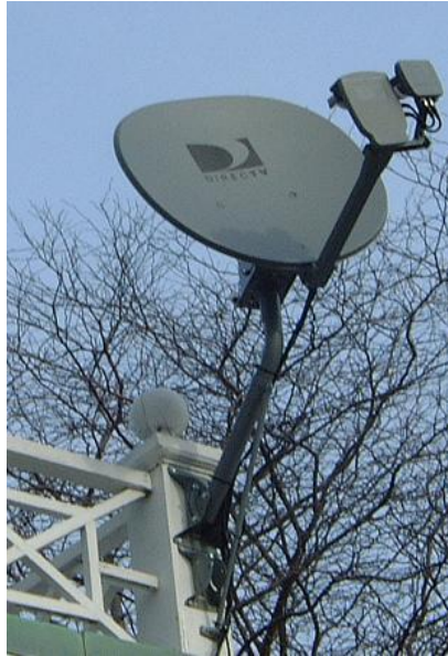
Figura 2.14 Antena con reflector parabólico para aplicaciones de televisión satelital
