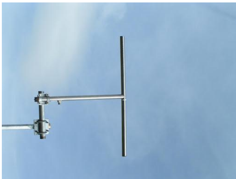
Figura 2.5 Antena tipo dipolo para radiocomunicaciones
