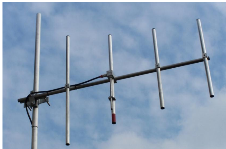
Figura 2.8 Antena tipo Yagi-Uda para aplicaciones de televisión
