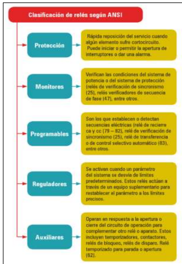
FIGURA 32 :RELÉS SEGÚN SU FUNCIÓN [3]
