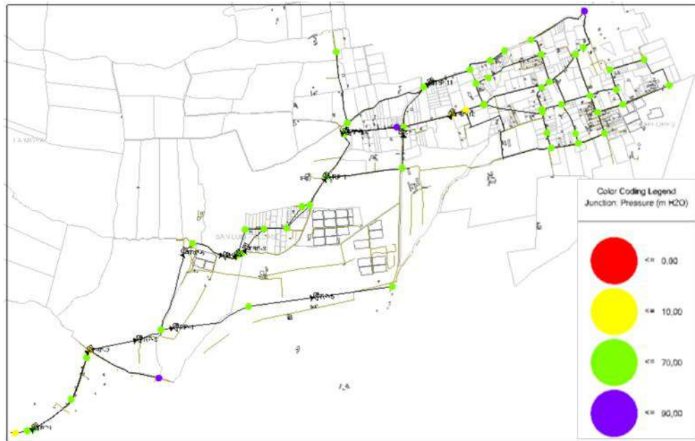
Figura 57. Presiones máximas y mínimas del sistema de distribución en período estático, 20 años, optimizado.
