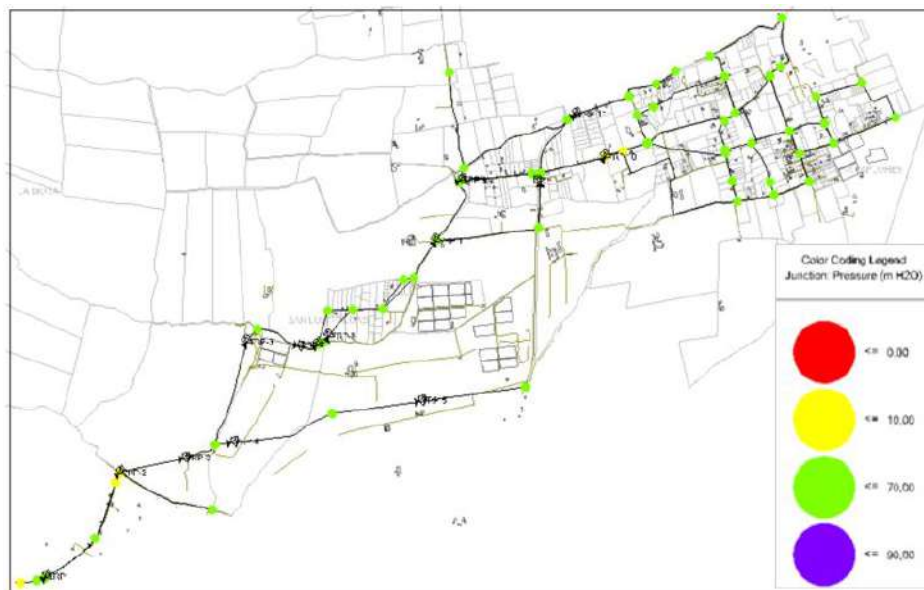
Figura 59. Presiones en horas de mayor consumo, optimización 20 años, período extendido. Elaborado por: Autores a través de WaterCAD, v. 2019.
