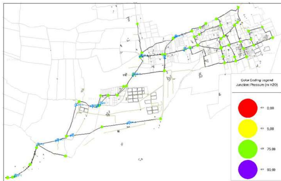
Figura 65. Presiones en meses de invierno, simulación para 30 años, optimizado Elaborado por: Autores a través de WaterCAD, v. 2019.
