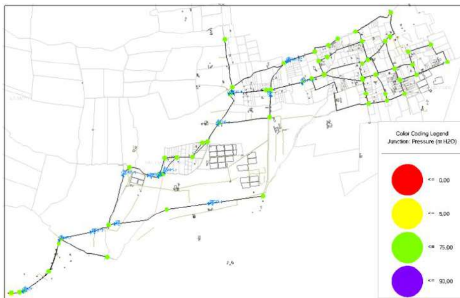
Figura 64. Presiones en meses de verano, simulación para 30 años, optimizado. Elaborado por: Autores a través de WaterCAD, v. 2019.
