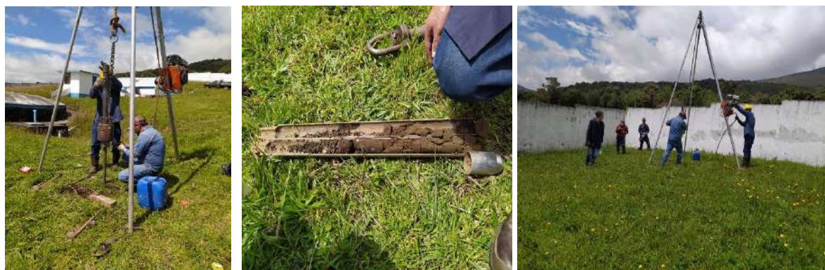
Fotografía 6. Ensayo SPT realizado en la planta de tratamiento Umbría.
