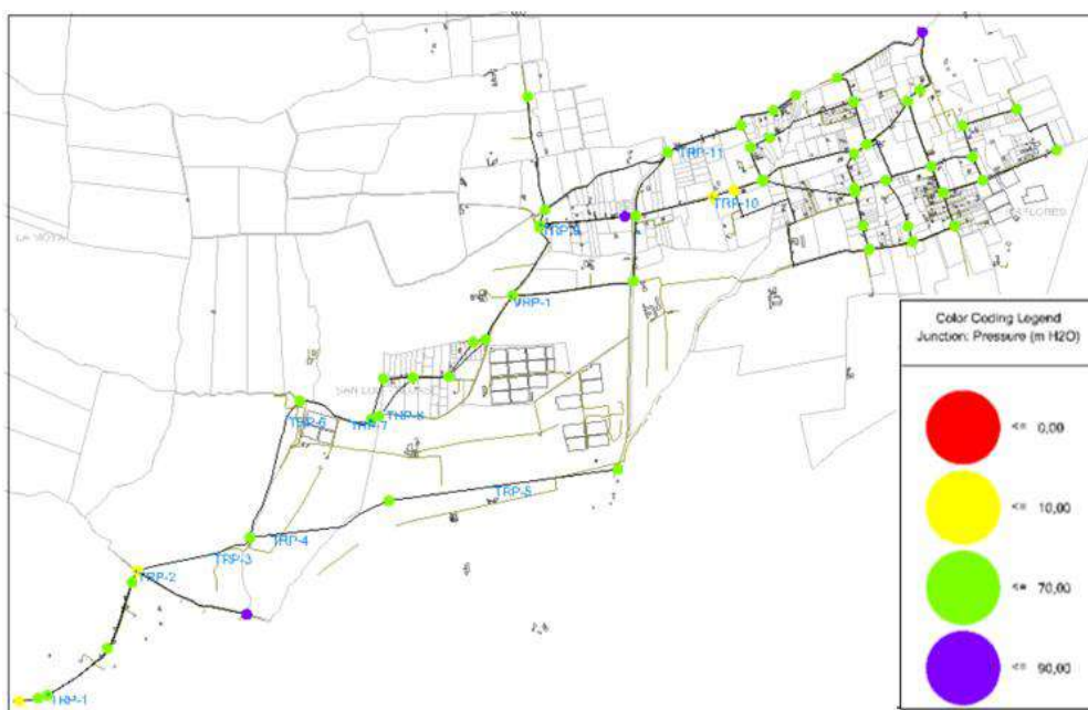
Figura 52. Presiones máximas y mínimas del sistema de distribución en período estático, 10 años, optimizado.
