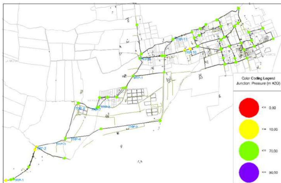
Figura 54. Presiones en horas de mayor consumo, optimización 10 años, período extendido. Elaborado por: Autores a través de WaterCAD, v. 2019.
