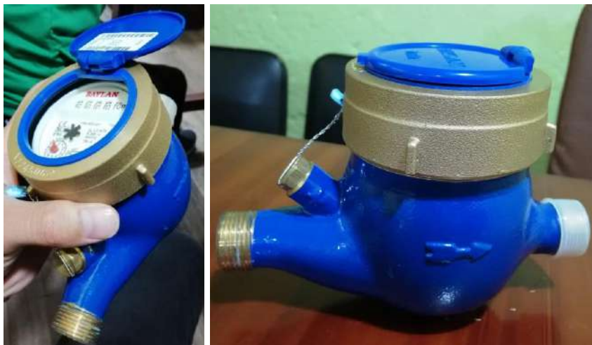
Fotografía 8. Micromedidores utilizados por la Junta Administradora de Agua Potable de Aloasí. Elaborado por: Autores.
