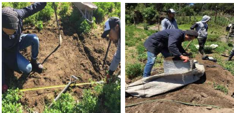
Fotografía 4. Calicata extraída en el área de proyecto para muestreo de suelos. Elaborado por: Autores.
