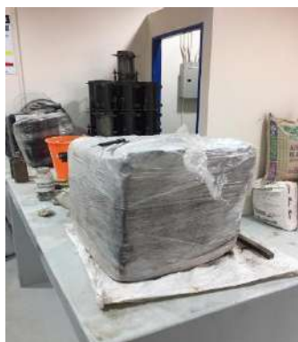
Fotografía 5. Calicata en laboratorio de suelos UPS, para los respectivos ensayos. Elaborado por: Autores.
