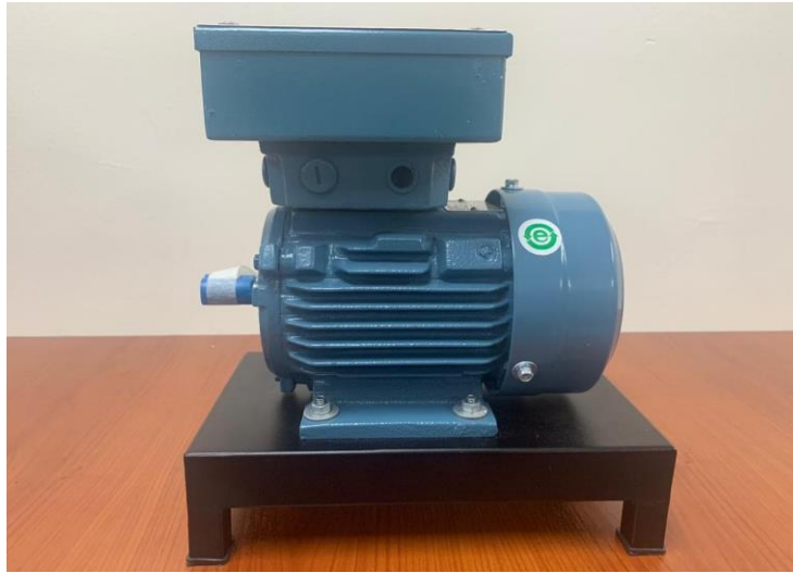
Figura 10. Motor Trifásico ABB.
