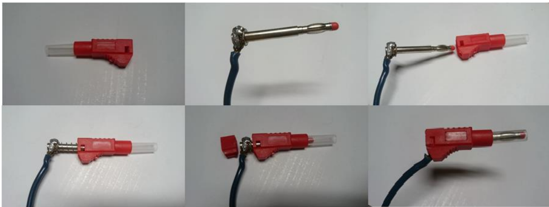
Figura 50. Proceso para elaboración de plugs banana.
