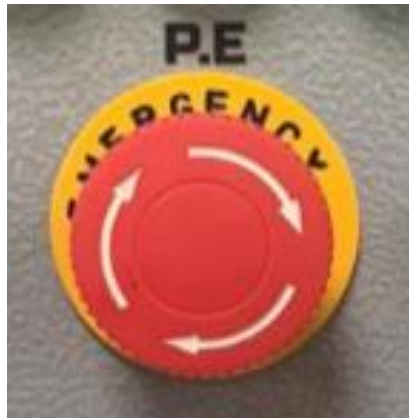
Figura 23. Paro de Emergencia.
