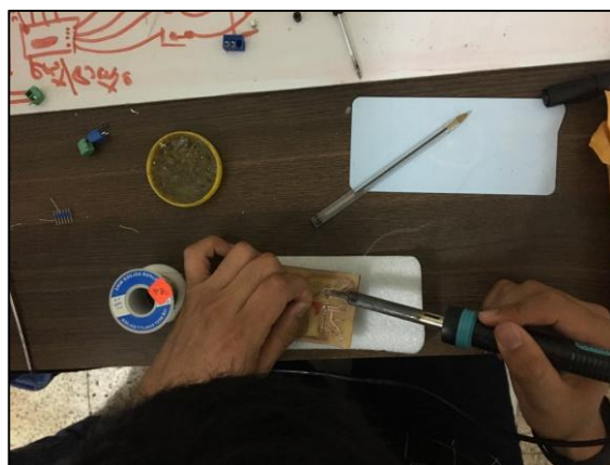
Figura 43- Soldado de componentes electrónicos en la placa para el microcontrolador arduino nano.
