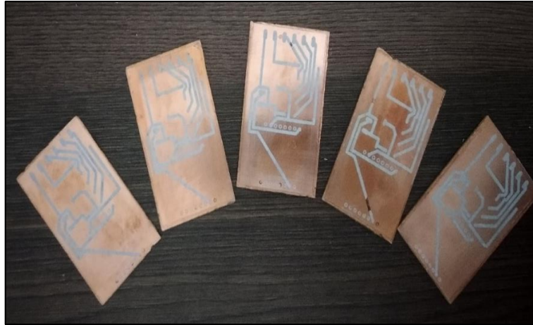
Figura 49- Diseño y elaboración de placa para comunicación wemos mini D1.
