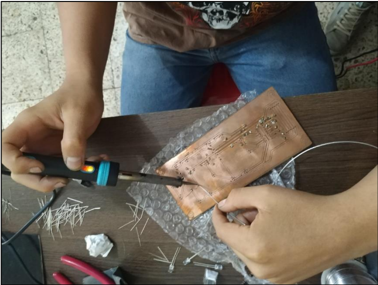
Figura 37- Proceso de soldado, placa de displays 7 segmentos.
