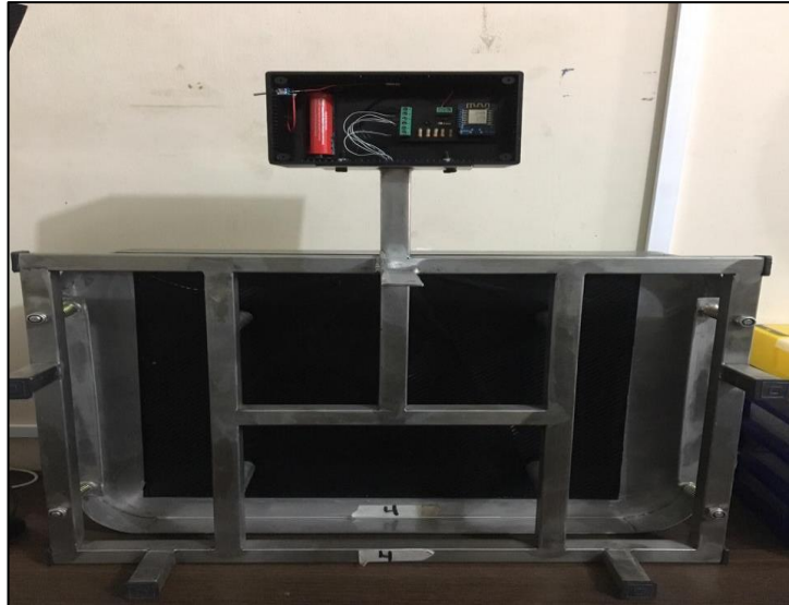
Figura 53- Armado completo de la estructura del sensor toque.
