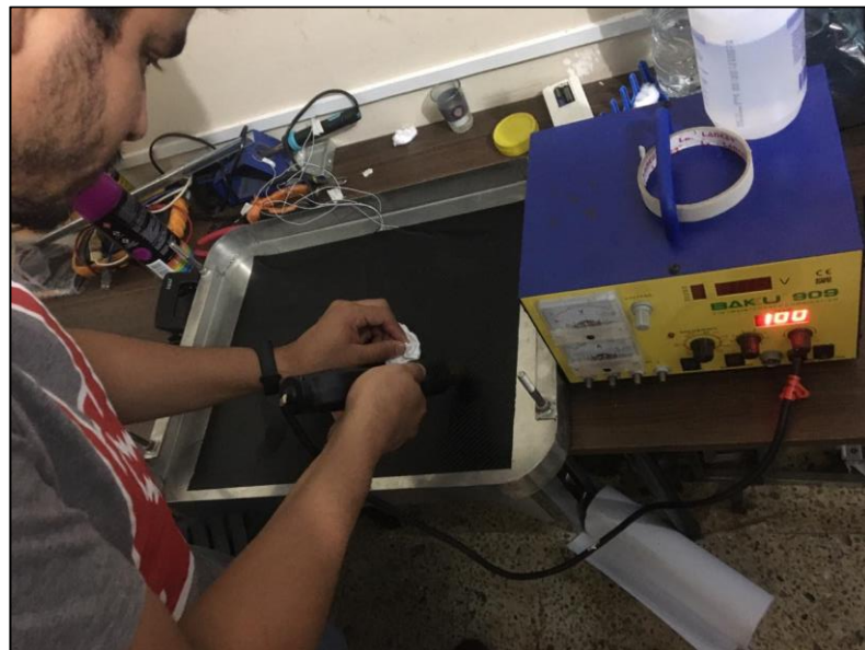
Figura 48- Colocación y sellado de piezoeléctricos en estructura.
