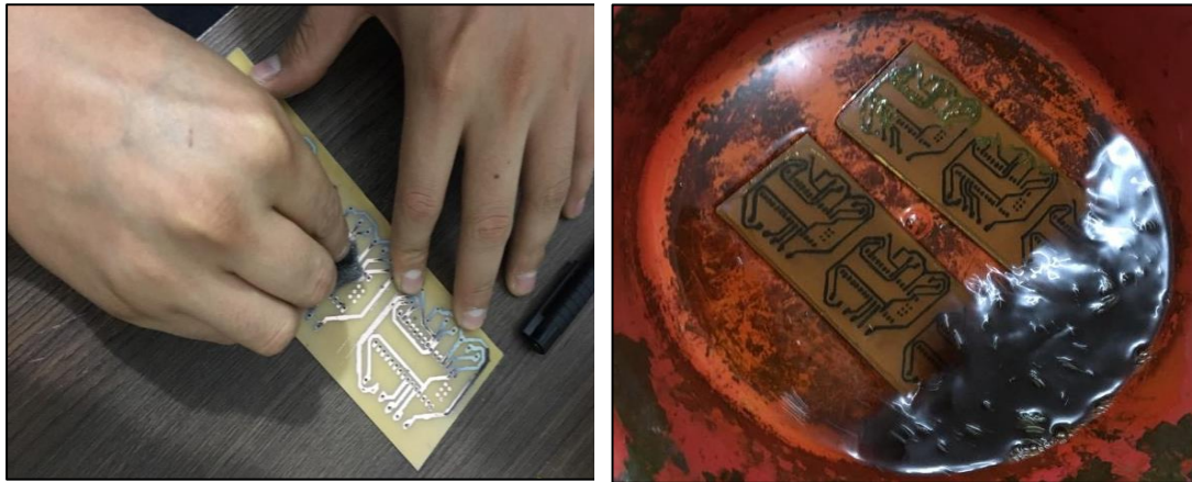
Figura 41- Pulido de placas y ácido actuando sobre la PCB para el microcontrolador arduino nano.
