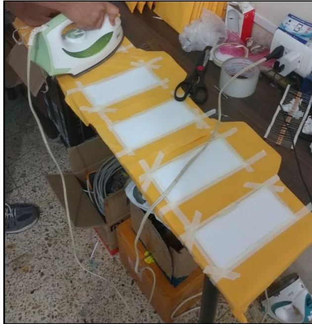
Figura 24- Planchado de placas display 7 segmento numérico.
