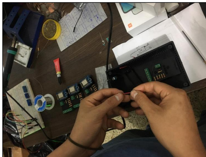
Figura 52- Armado del módulo cajetín de wemos mini D1.
