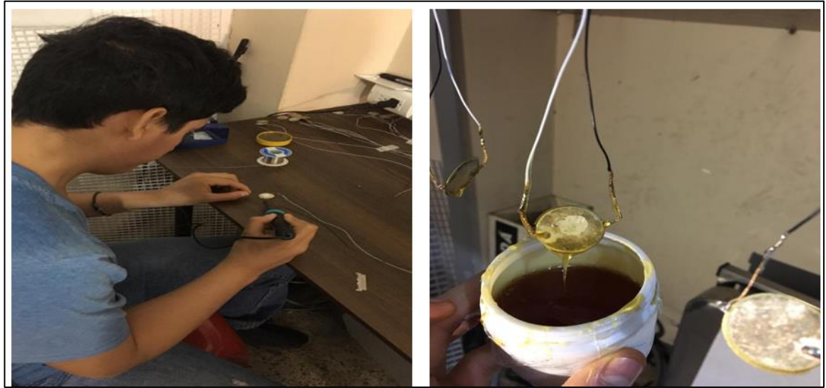
Figura 47- Soldado y barnizado de piezoeléctricos
