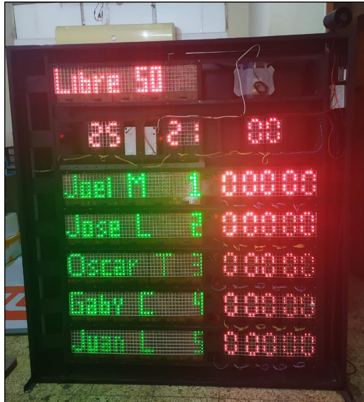
Figura 101- Datos obtenidos de la interfaz web enviados al visualizador electrónico.
