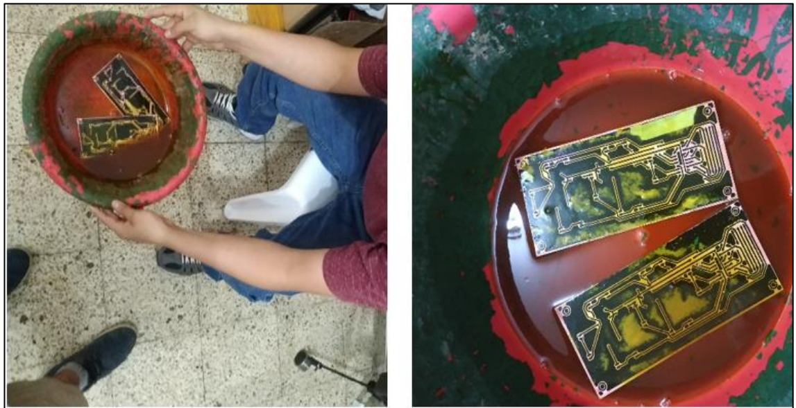
Figura 32- Ácido actuando en placas 7 segmentos.
