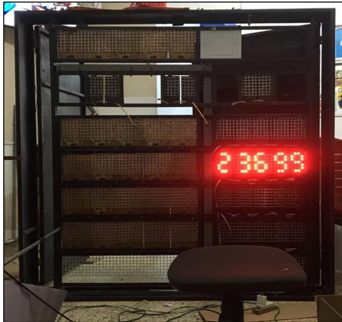
Figura 93- Cableado, encendido y prueba de las placas de display siete segmentos.
