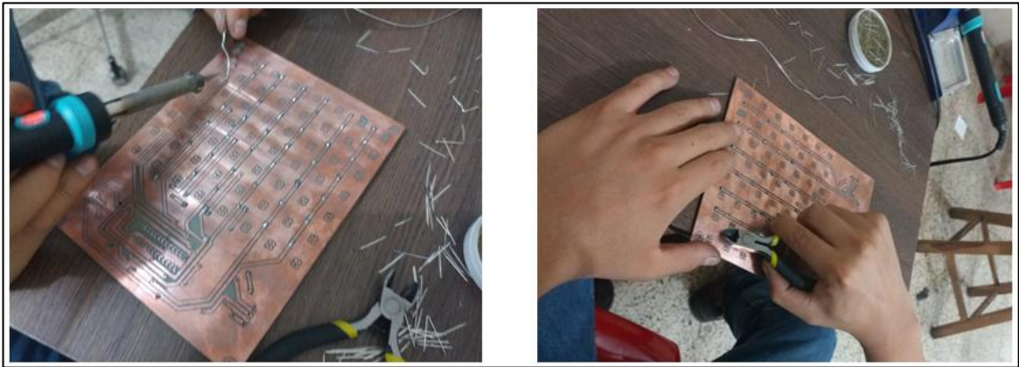
Figura 36- Proceso de soldado vista delantera de placa de Matriz 8x7.
