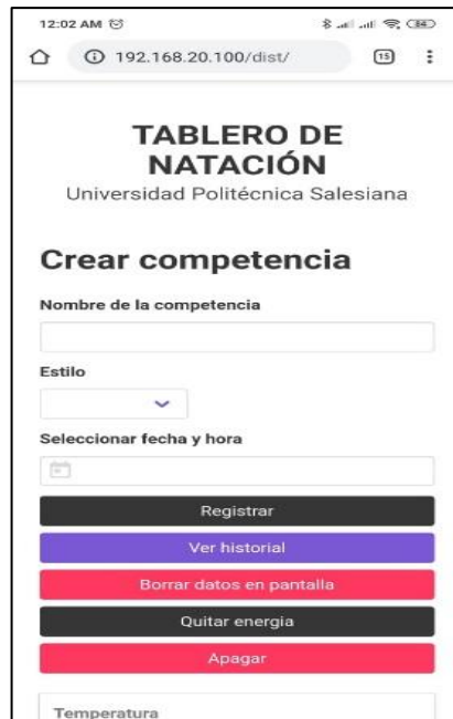
Figura 96- Respuesta del servidor con la interfaz web vista desde un smartphone.
