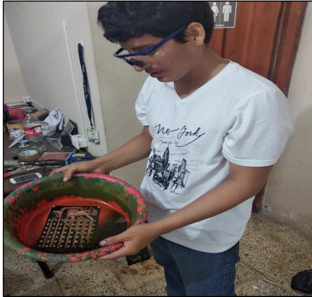
Figura 33- Ácido actuando en matrices 8x7.
