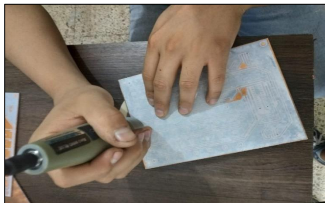
Figura 30- Perforación de matriz 8x7 vista frontal.
