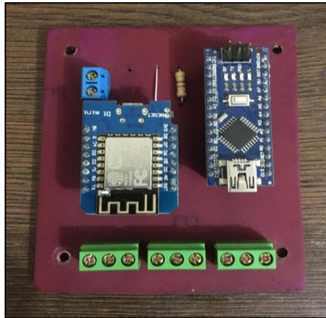
Figura 54- Placa de conexión entre sensores del estado físico químico del agua arduino nano-wemos D1
