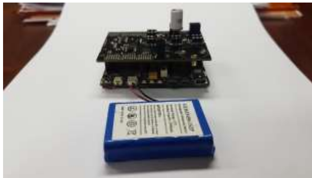
Figura 99. Conexión del equipo de medición a la batería de litio.
