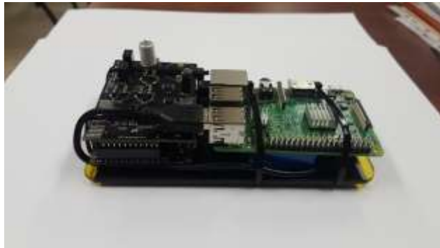
Figura 100. Conexión del equipo de medición al gateway (RaspberryPi3).
