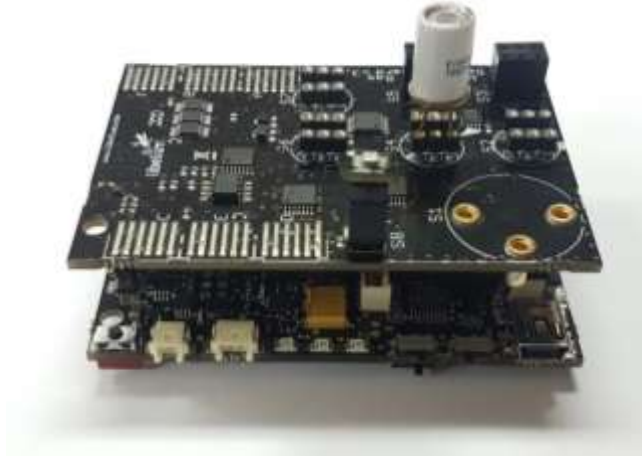
Figura 98. Acoplamiento de sensores con el lector de gases y la tarjeta Wasp mote.
