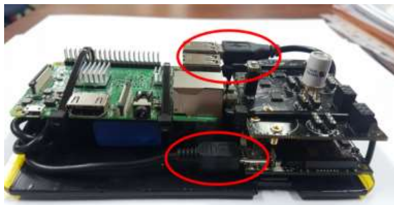
Figura 73. Conexión entre Wasmote y Raspberry Pi. Fuente: elaboración propia.
