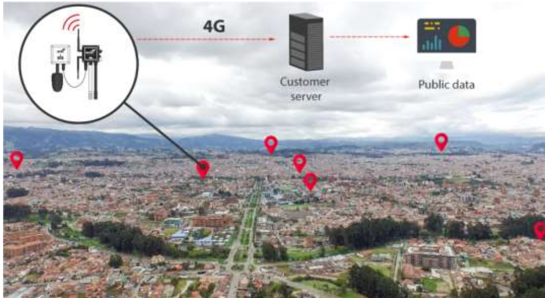
Figura 37. Diagrama de instalación del nivel de sensor de ruido. Fuente: Libelium World ( http://www.libelium.com/libelium-helps-to-reduce-noise-pollution-in-the-city-of-cuenca-ecuador/#!prettyPhoto-img[46120]/1/ ).
