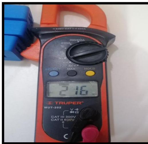
Figura 29. Voltaje medido con pinza amperimétrica Truper.
