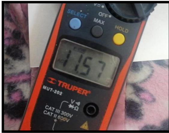
Figura 30. Corriente medida con Pinza amperimétrica Truper.
