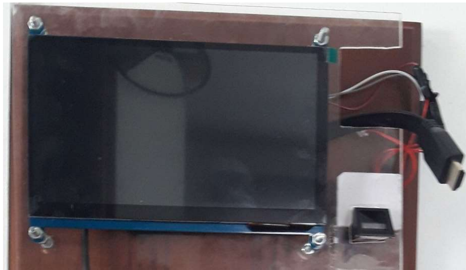
Figura 4.6 Instalación del LCD en el Tablero del prototipo de marcación Fuente: Los autores
