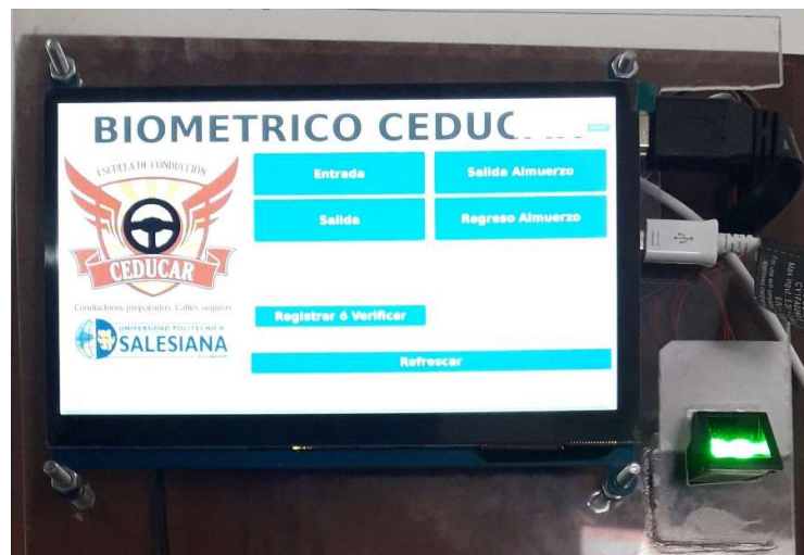
Figura 4.8 Funcionamiento del prototipo de marcación en la escuela de manejo CEDUCAR Fuente: Los autores
