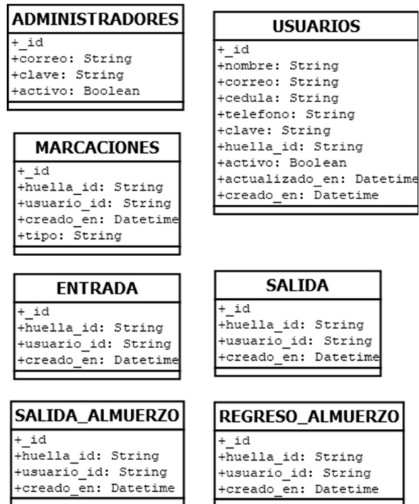
Figura 3.13. Estructura final de los datos de sistema de marcación. Fuente: Los autores.
