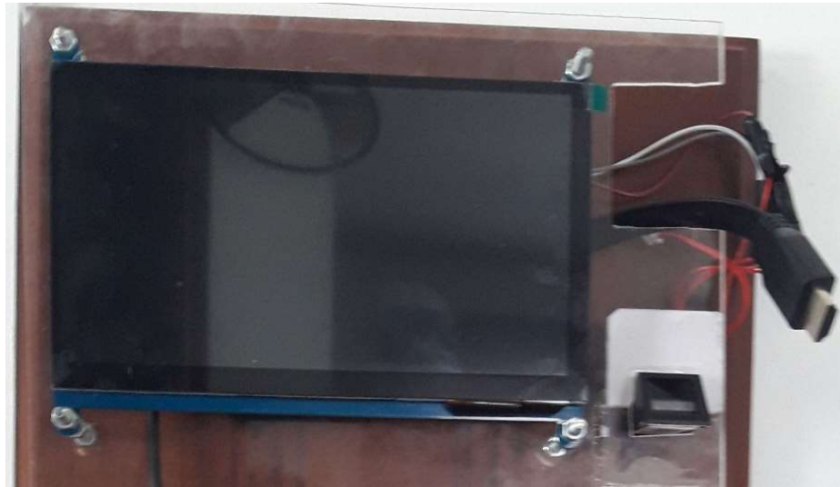
Figura A.22 Instalación del LCD en el Tablero del sistema de marcación Fuente: Los Autores
