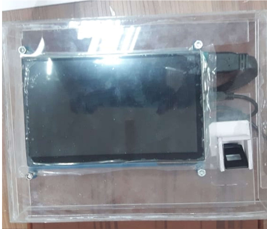
Figura 4.5 Elaboración del acrílico de la estructura general del prototipo de marcación. Fuente: Los autores.
