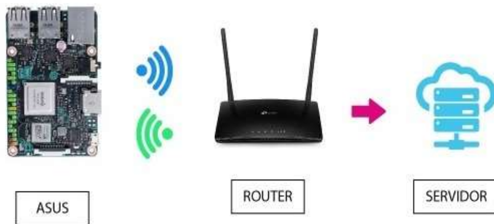
Figura 3.1 Diagrama de conexión de datos de la tarjeta asus tinker board al sistema de marcación del servidor de Ceducar Fuente: Los Autores.
