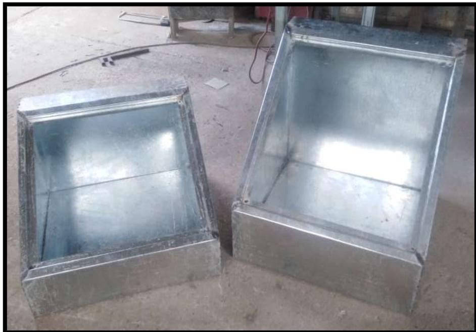
Figura 3.3: Estructura galvanizada al frío módulos maestro esclavo.
