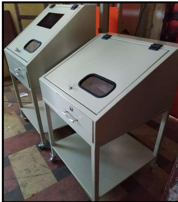
Figura 3.4: Estructura galvanizada al frio módulos maestro esclavo con acabado terminado.
