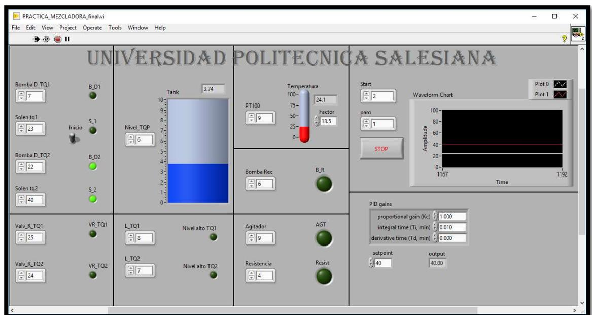
Cuando el agua en el tanque principal (Tank) llega a un nivel de 3,5 se desactiva (BD1) y (S\_1) y se activa la bomba de descarga 2 (B\_D2) y Solenoide 2 (S\_2) y empieza el vaciado del tanque 2.
