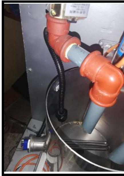
Figura 3.12: Ubicación de resistencia térmica
