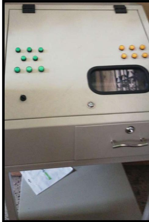
Figura 3.7: Vista externa del tablero ya integrado luces piloto.
