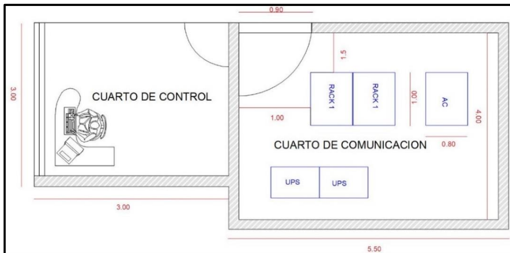
Figura 3.4 Cuarto de Comunicaciones
