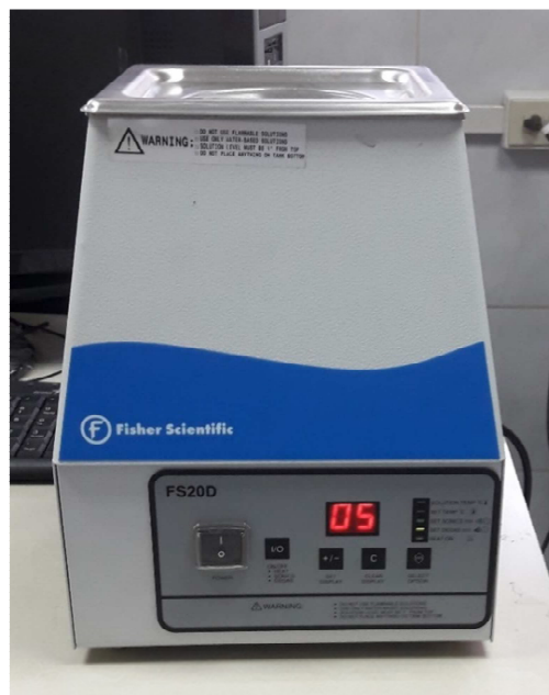
Fotografía N°2. Equipo utilizado para la aplicación de Ultrasonido
