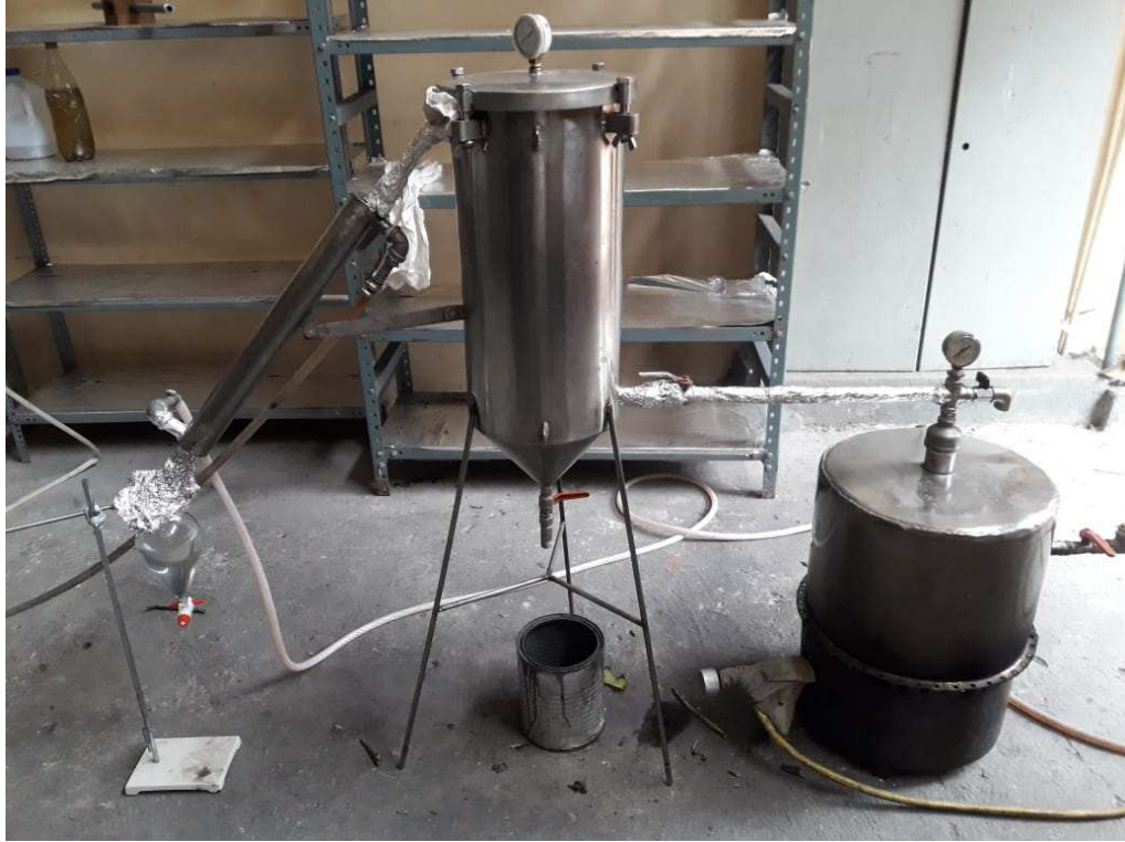
Figura 3. Equipo industrial de destilación por arrastre de vapor
