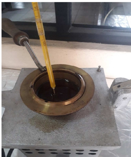
Fotografía 9. Prueba para determinar el punto de inflamación en aparato Cleveland.
