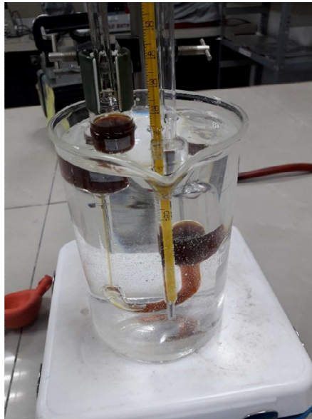
Fotografía 16. Prueba en viscosímetro de ostwald para calcular el tiempo de flujo del hidrocarburo.
