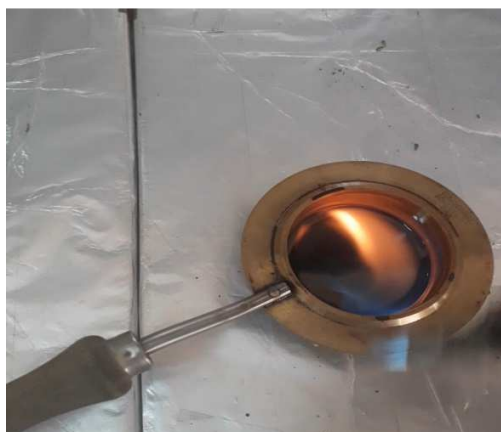
Fotografía 17. Determinación del punto de inflamación del hidrocarburo de pirólisis.
