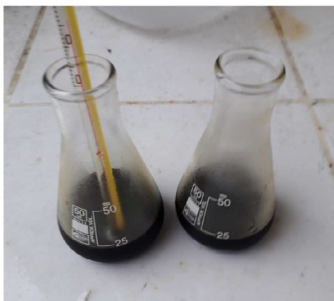
Fotografía 18. Determinación del punto de congelación del hidrocarburo de pirólisis.
