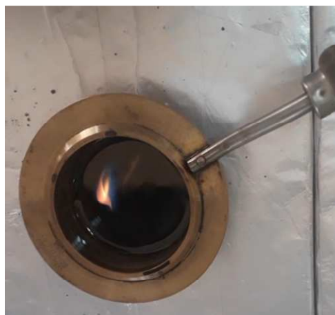
Fotografía 20. Determinación de punto de inflamación del hidrocarburo de gasificación.
