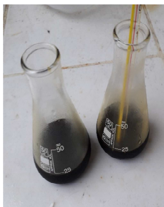
Fotografía 21. Determinación del punto de congelación del hidrocarburo de gasificación.
