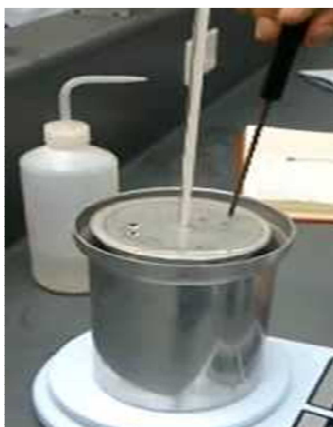
Fotografía 11. Determinación de la temperatura de equilibrio en calorímetro.
