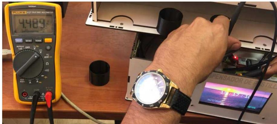
*Figura 31. Voltaje de operación de la pantalla Nextion.*
