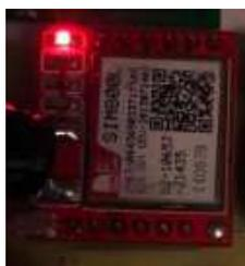
**Figura 23. Módulo SIM800L encendido. Elaboración propia**
