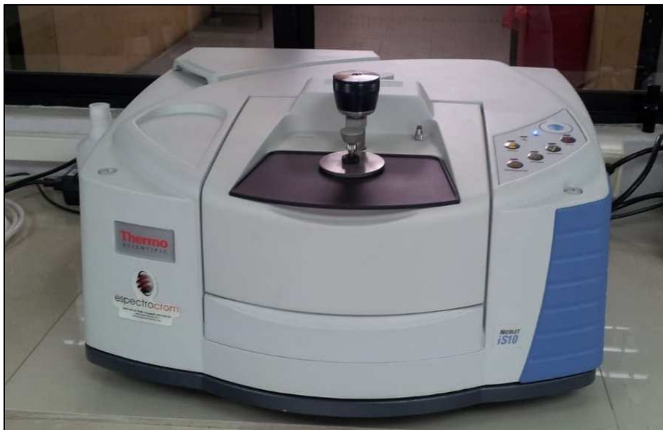
Anexo 9: Equipo FTIR THERMO SCIENTIFIC, modelo NICOLET i510 serie 912A0607.
