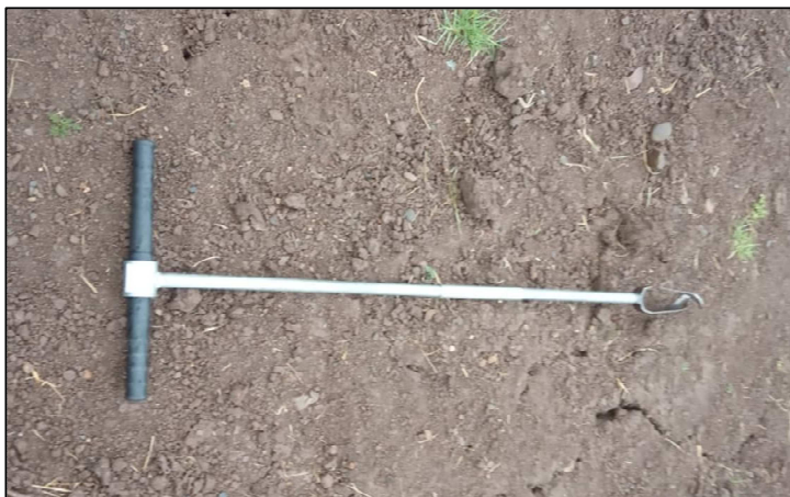
Fotografía 1: Barreno para extracción de muestras del relleno sanitario.
