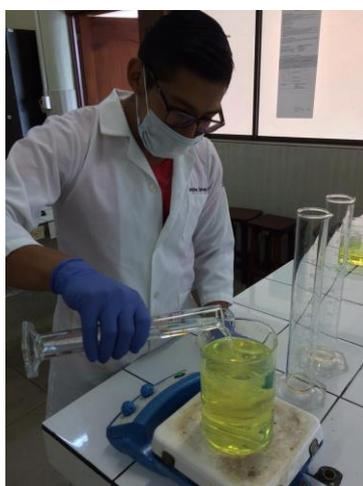
**Figura 27** Introducción de n-butanol en el vaso de ensayo.
