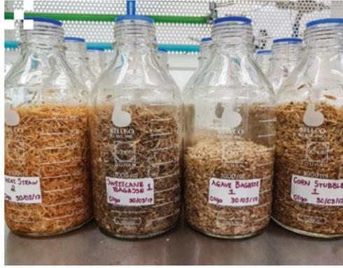
**Figura 5 Materia prima para la producción de Biobutanol**
