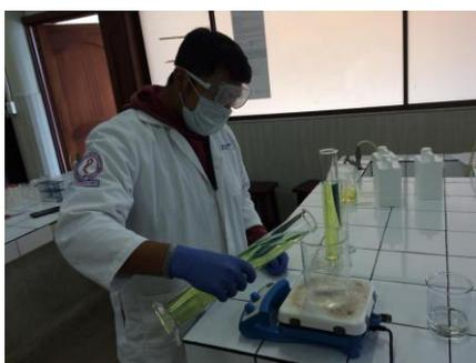
**Figura 25 Introducción del diésel en el vaso de ensayo.**
