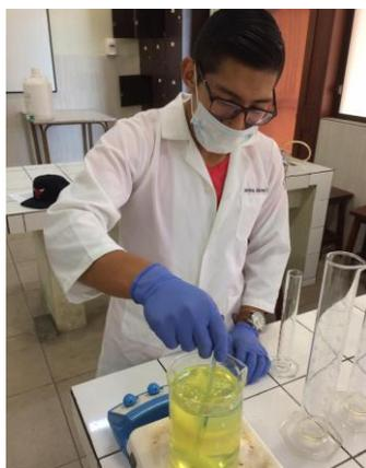
**Figura 28** Mezcla de porcentajes de diésel con n-butanol.
