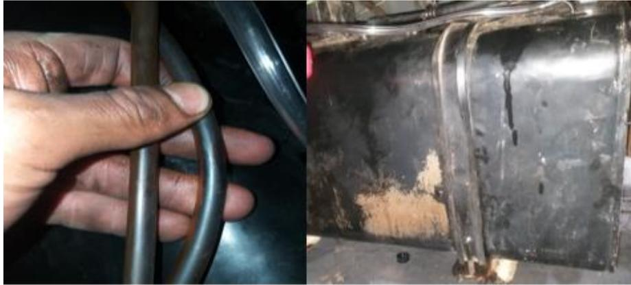
**Figura 17 Cambio de cañerías de combustible.**
