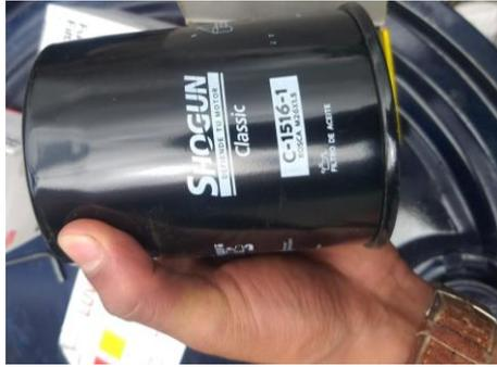
**Figura 15 Cambio del filtro de aceite de motor.
