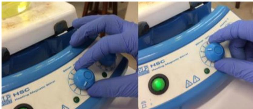
**Figura 29 Mezcla diésel con n-butanol de 1000 a 4000 rpm.**
