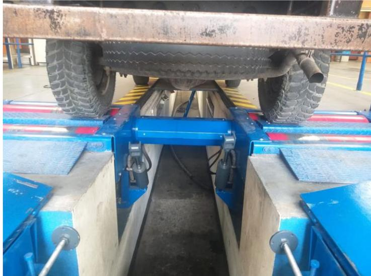
**Figura 35** Posicionamiento de las ruedas sobre los rodillos.
