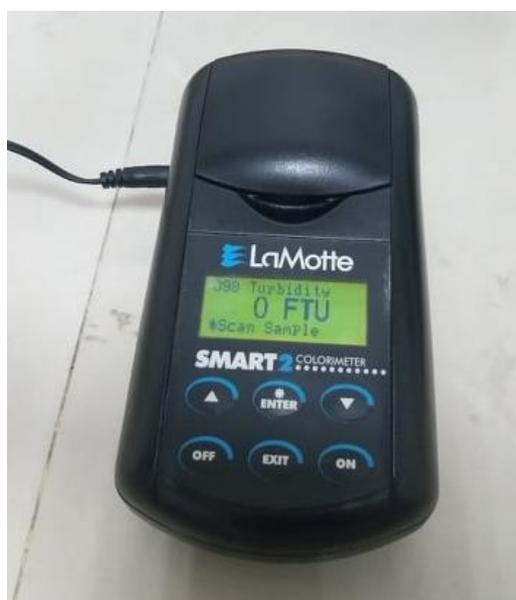
**Figura 65 Resultado del punto de turbidez de los combustibles.
