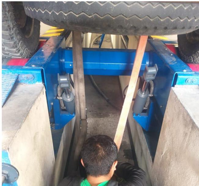
**Figura 36** Sujeción del vehículo con los puntos de anclaje.
