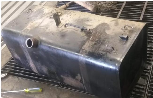
**Figura 16 Desmontaje y limpieza del tanque de combustible.
