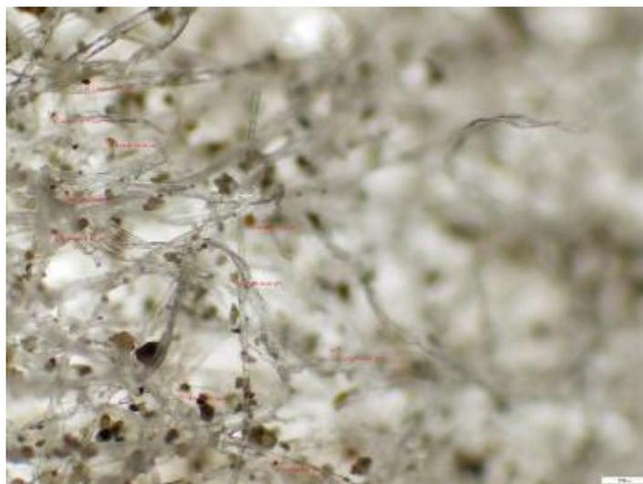
*Figura. 15. FILTRO DE AIRE DONSSON SECUNDARIO CONTAMINADO.*
