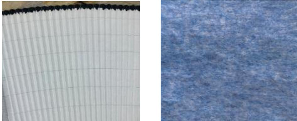
Figura. 8. TIPO DE MATERIAL DE LOS FILTROS DE AIRE (PAPEL FILTRANTE Y ALGODÓN).
