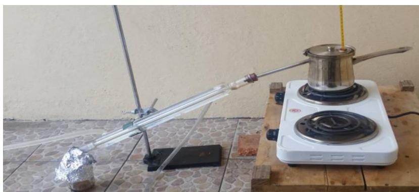
Imagen 17 Proceso de craqueo del aceite lubricante usado.
