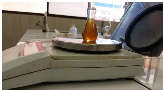
Imagen 8 Equipo para determinar la densidad del aceite lubricante usado.
