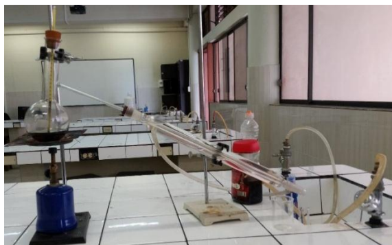
Imagen 19 Proceso de rectificación del lubricante usado
