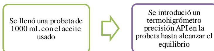
Figura 11 Procedimiento para determinar la Gravedad API. Fuente: Las Autoras.
