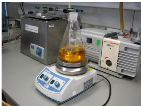
Imagen 7 Matraz Erlenmeyer en un agitador magnético
