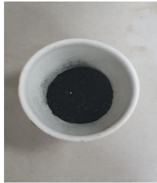
Imagen 28 Residuo Carbonoso en el fondo del crisol.
