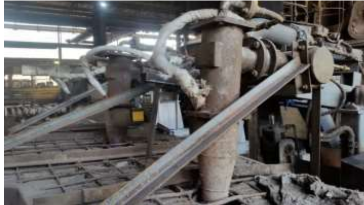
Figura 3.4 Tapa superior del Tundish
