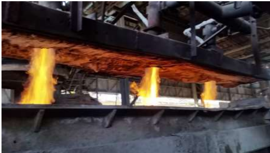
Figura 4.5 Control de flamas para el calentamiento del Tundish
