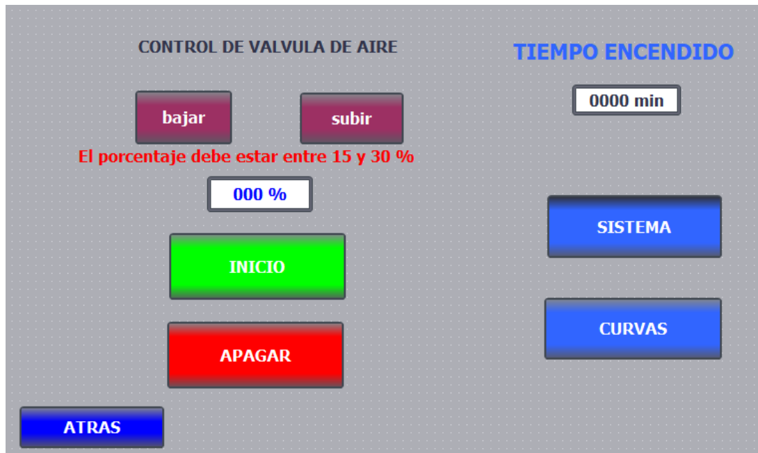
Figura 3.11 Pantalla HMI modalidad Manual Opción 1
