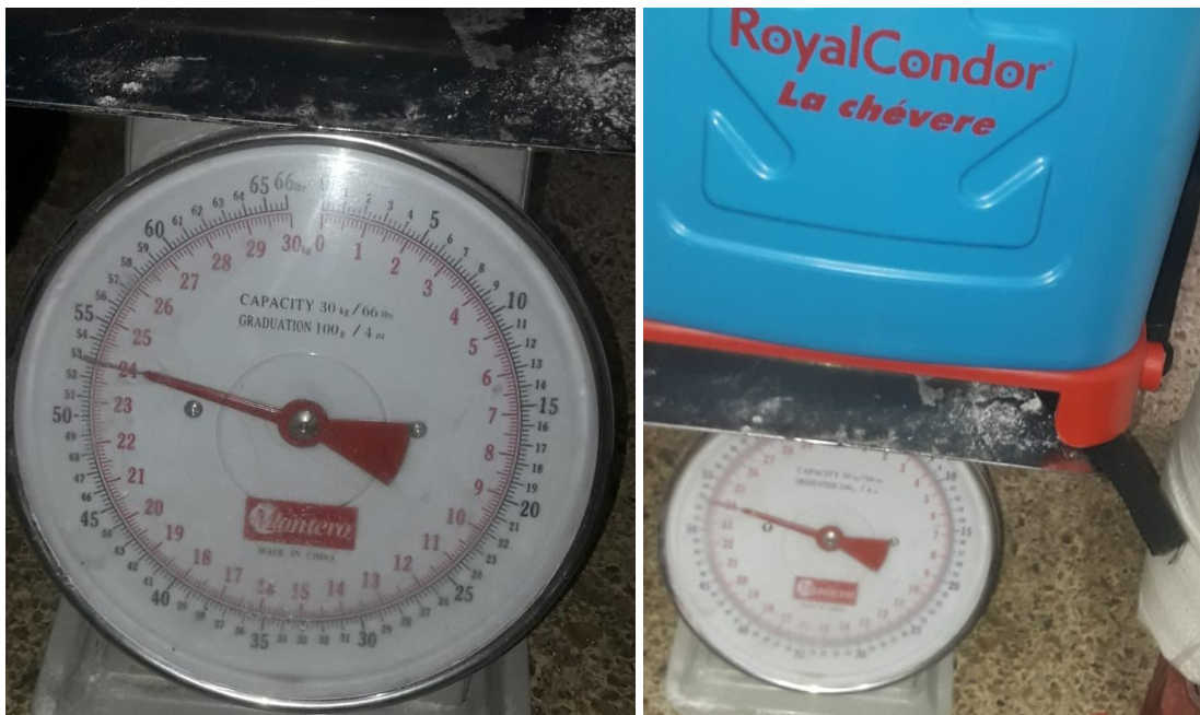
Anexo 6: Medida del peso de la bomba de fumigar con 20 L de agua
