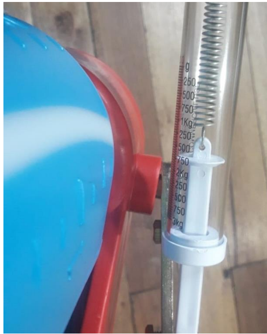
Anexo 7: Medida de la fuerza de bombeo del pistón utilizando un dinamómetro
