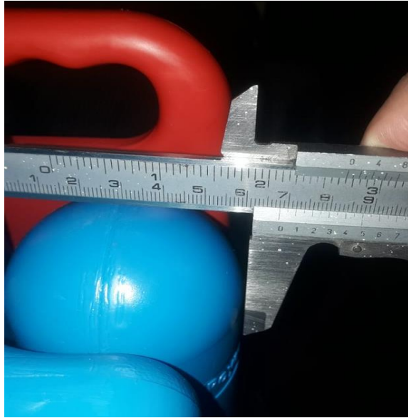
Anexo 18: Medición del diámetro de la cámara del cilindro
