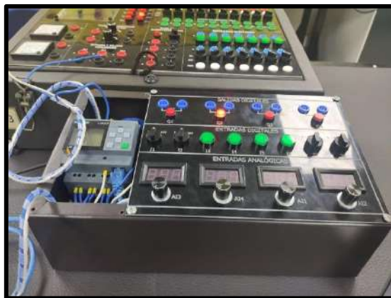
Ilustración 64: Simulación de porta fusible desconectado en Logo, PLC S7-1200 y LabVIEW
