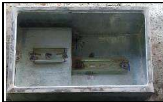
Ilustración 10: Vista del módulo en etapa de soldadura
