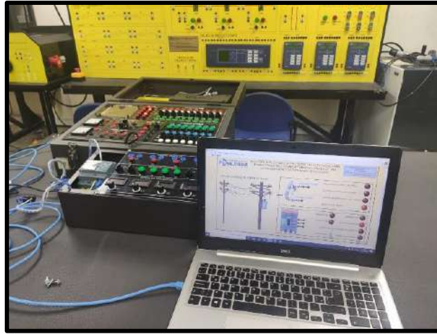
Ilustración 62: Sensores no conectados, se activan las fallas por sensores inactivos en labVIEW y PLC S7-1200
