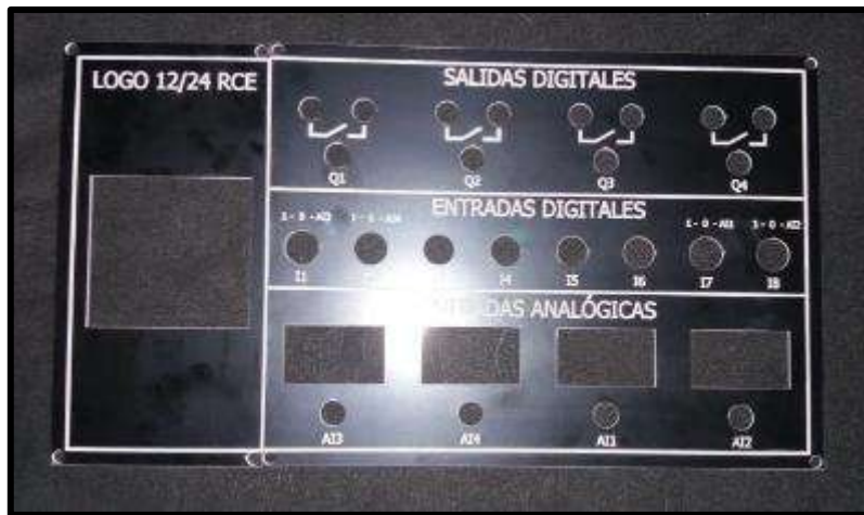
Ilustración 9: Vista superior de la placa de señales
