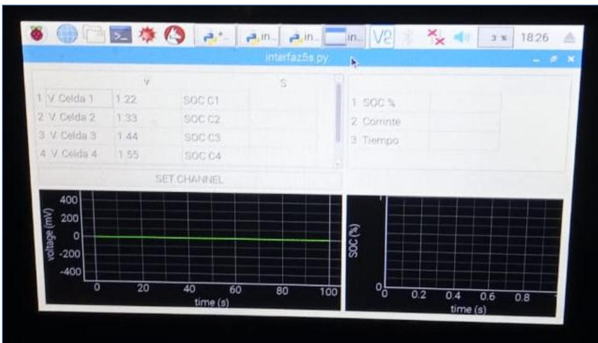
Ilustración 35 Interfaz de visualización y monitoreo de parámetros. Fuente: Autores
