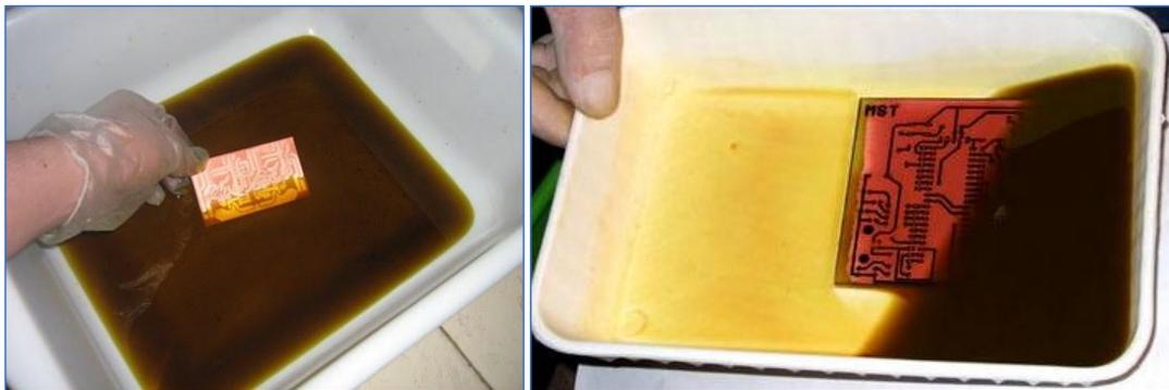
*Ilustración 28 Proceso de revelado o quemado de la PCB. Fuente: Autores*
