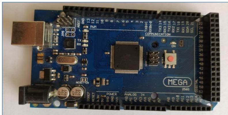
*Ilustración 22 Arduino Mega 2560. Fuente: Autores*
